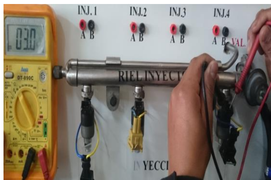
Figura 75 Resistencia en el inyector 4
