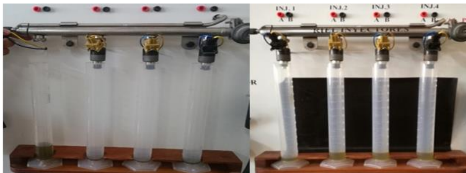
Figura 46 Instalación de los inyectores y respectivas probetas
