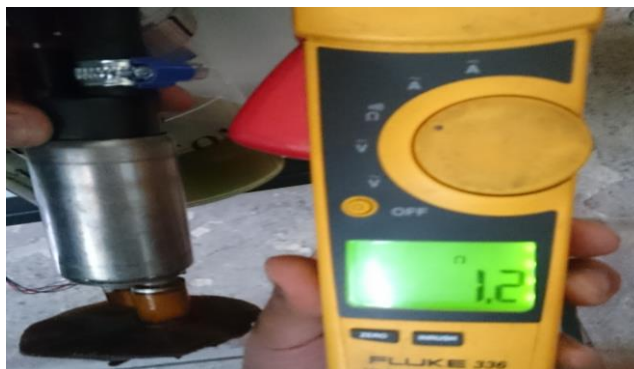
Figura 70 Resistencia de la bomba de combustible
