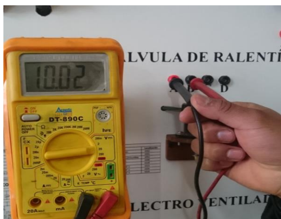
Figura 58 Voltaje entre los pines A y B
