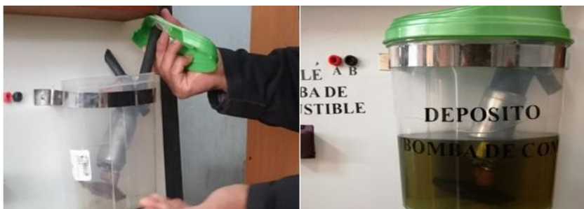
Figura 44 Instalación de la bomba de combustible y depósito
