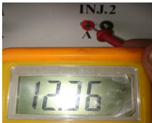
Figura 77 Voltaje en el inyector 2
