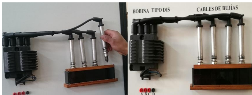
Figura 43 Ubicación de bobina, cables y bujías
