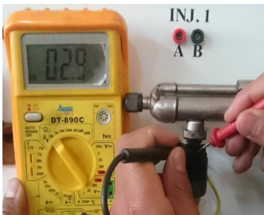
Figura 72 Resistencia en el inyector 1
