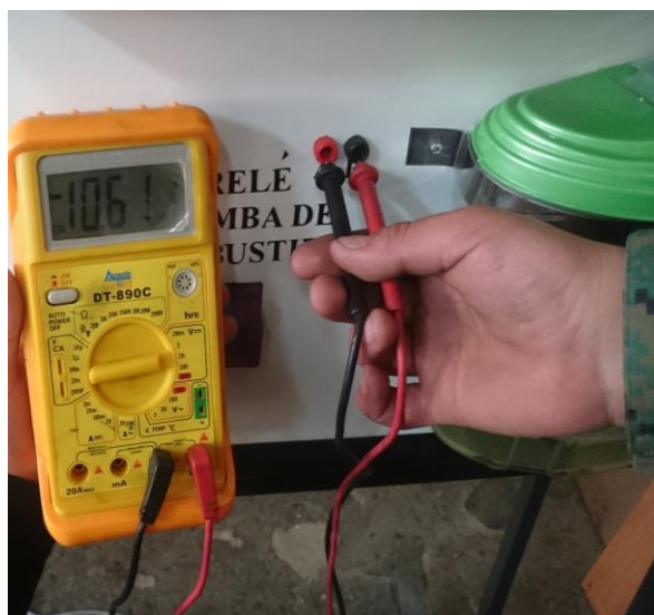
Figura 69 Voltaje de la bomba de combustible
