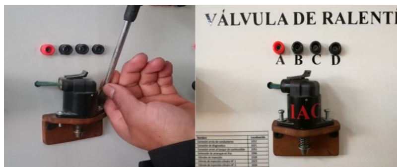
Figura 42 Ubicación y ajuste de la válvula (IAC)
