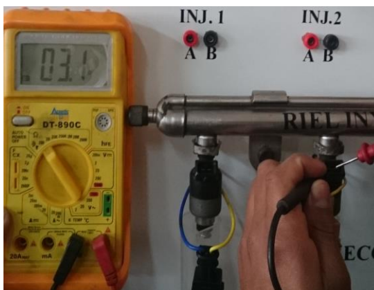
Figura 73 Resistencia en el inyector 2
