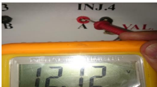
Figura 79 Voltaje en el inyector 4
