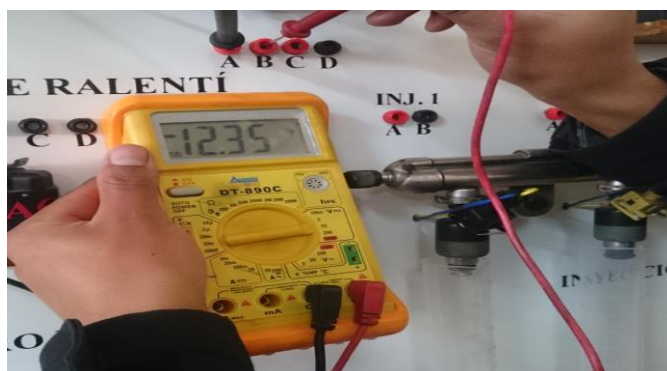
Figura 63 Voltaje en la bobina DIS
