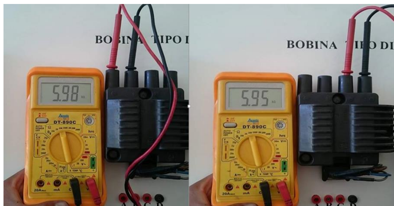
Figura 62 Resistencia en la bobina DIS
