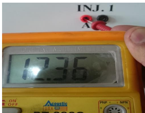
Figura 76 Voltaje en el inyector 1
