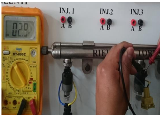
Figura 74 Resistencia en el inyector 3
