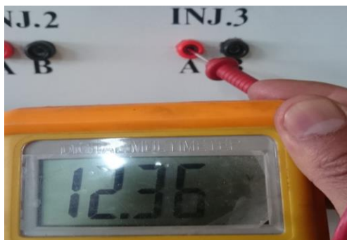
Figura 78 Voltaje en el inyector 3
