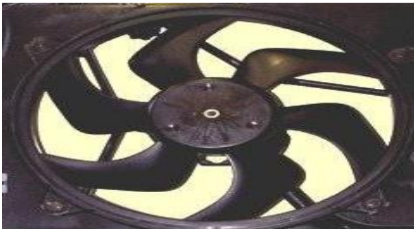
Figura 35 Ventilador eléctrico de dos velocidades
