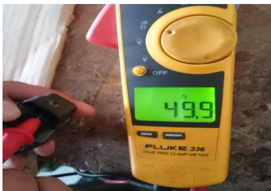
Figura 56 Resistencia entre pines A y B
