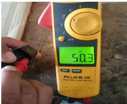
Figura 57 Resistencia entre pines C y D
