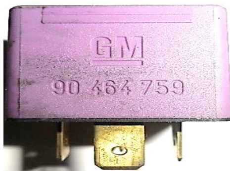
Figura 26 Relé gm de la bomba de combustible
