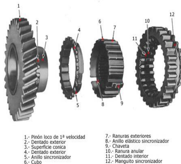
Figura 22 Despiece parcial de un sincronizado
