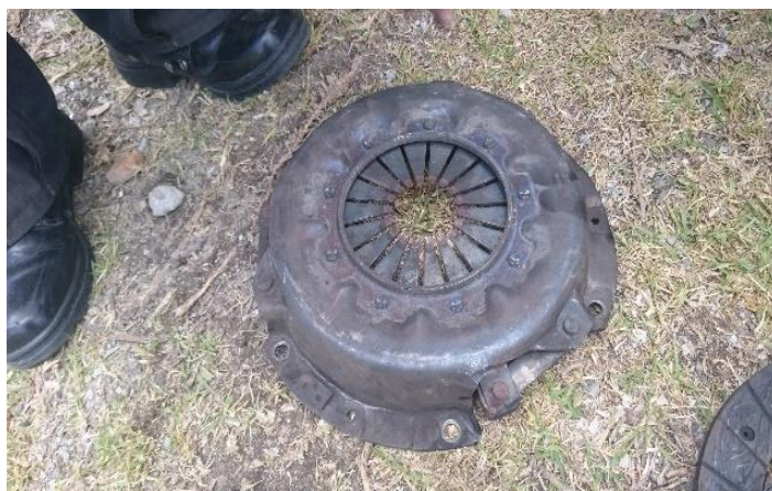
Figura 43 Verificar estado del palto de presión
