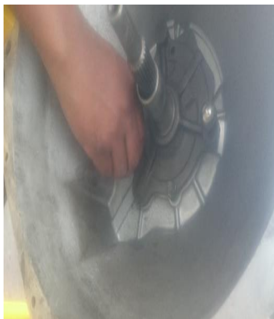
Figura 73 Colocación de los pernos
