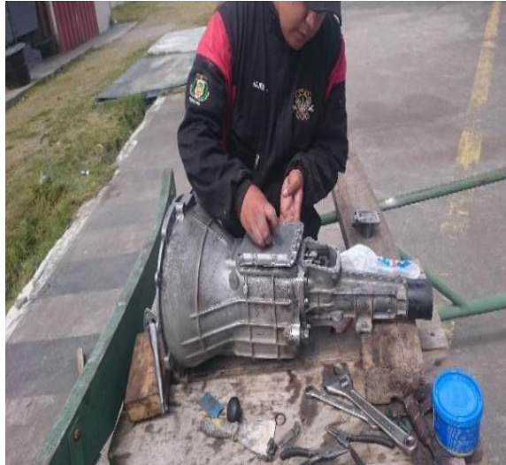
Figura 77 Colocando Placa superior
