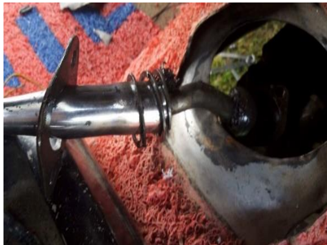
Figura 32 Desmontaje palanca de cambios
