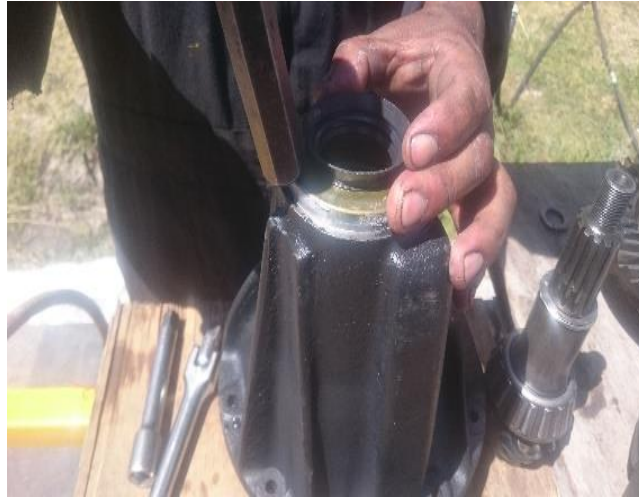
Figura 85 Cambio de retenedor
