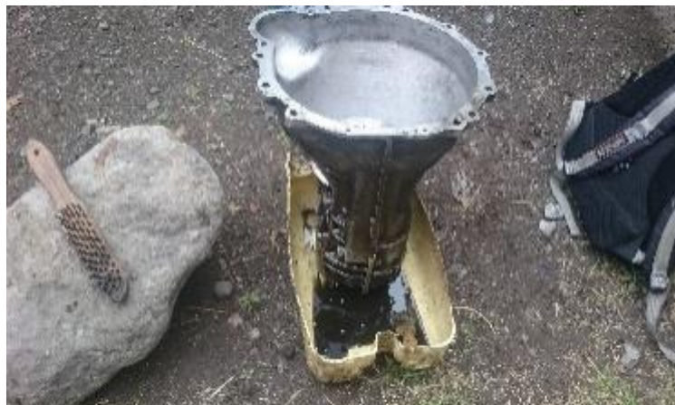
Limpieza de la carcasa caja de cambios
