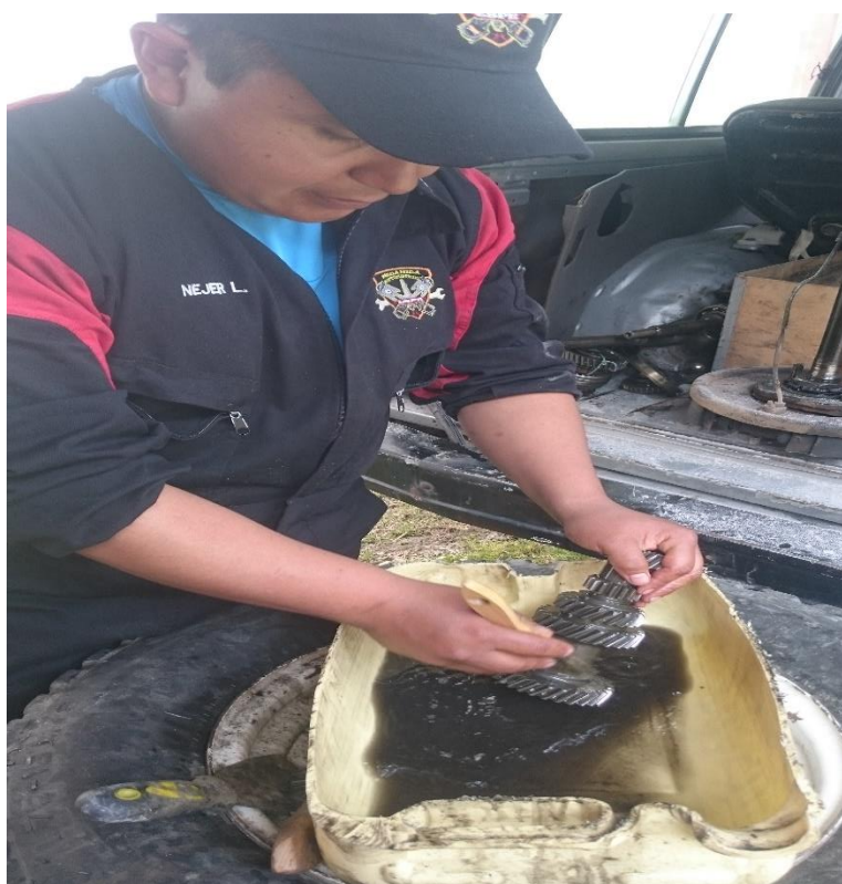
Limpieza de eje primario y secundario
