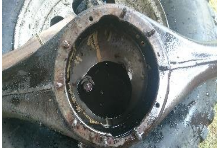
Limpieza de la funda del diferencial
