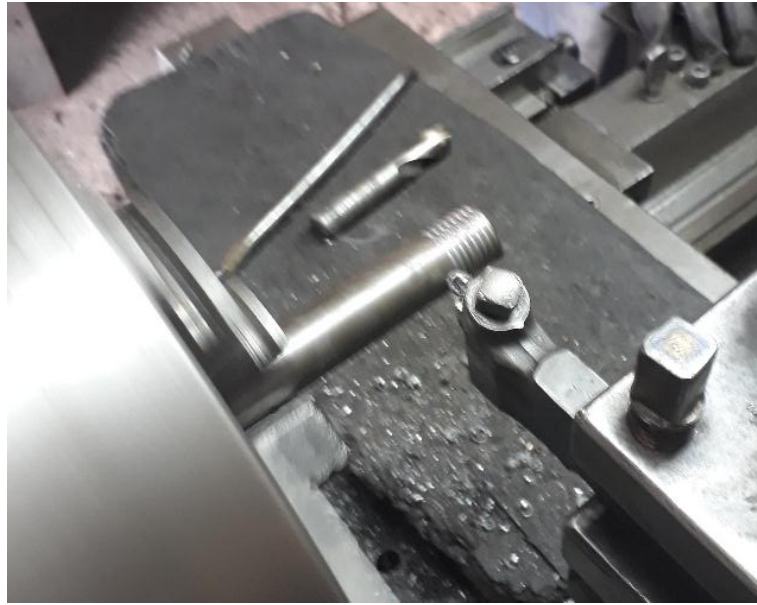
Figura 43 Roscado parte lateral del eje.
