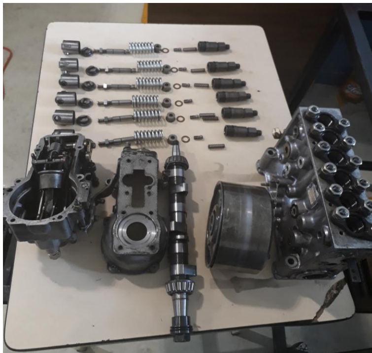
Figura 66 Partes internas y externas de la bomba lineal Tipo P
