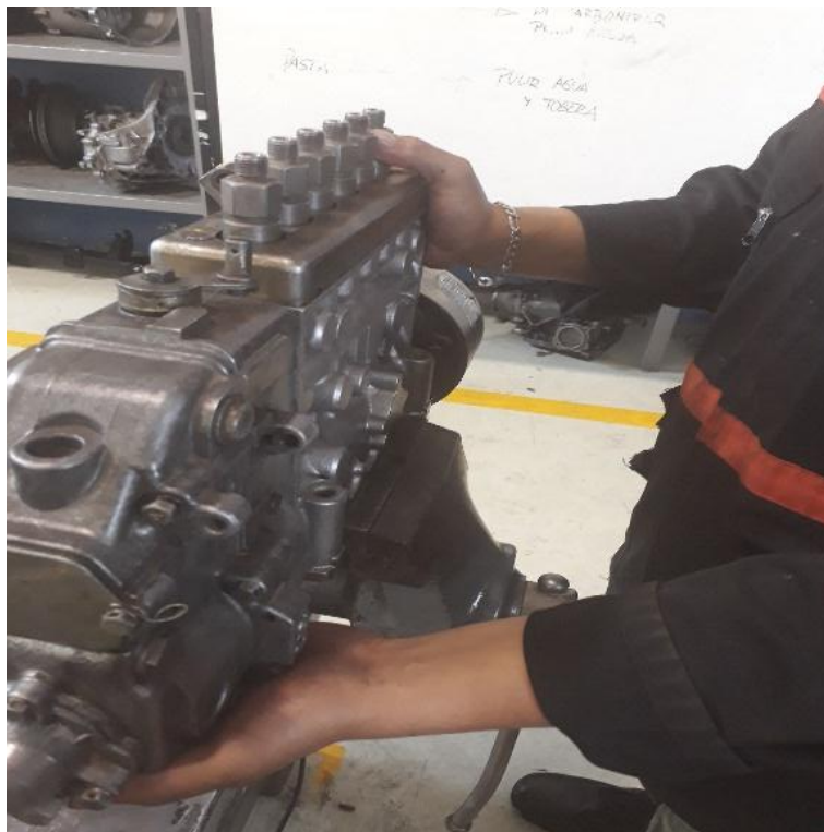
Figura 46 Montaje de la bomba en una prensa.
