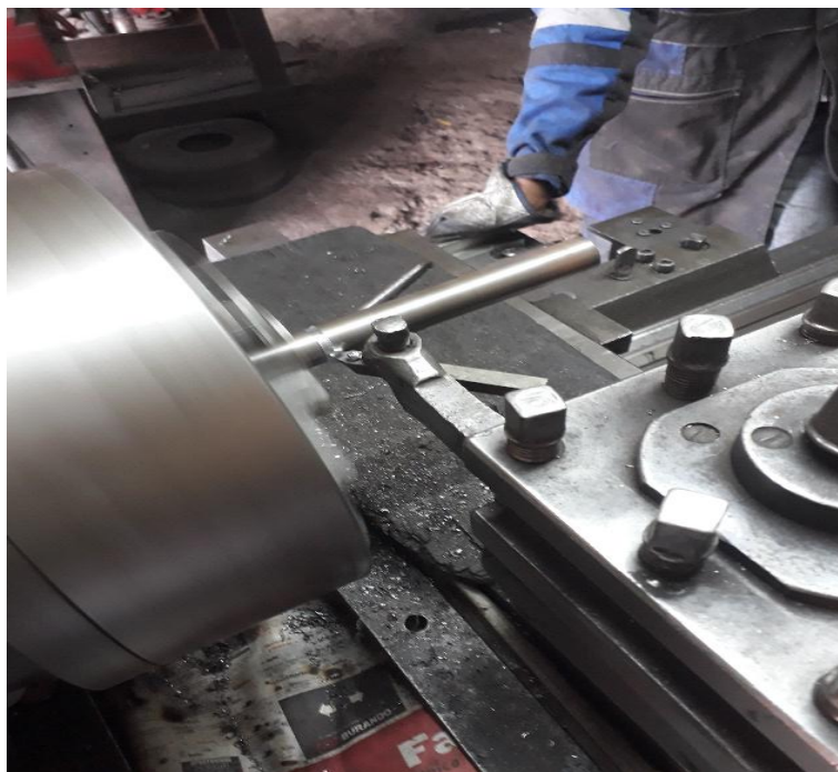
Figura 42 Desbaste del eje.
