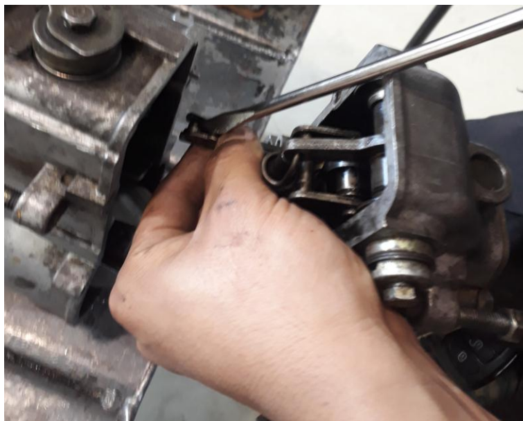
Figura 48 Extracción del seguro de la unión de la Cremallera y horquilla de aceleración
