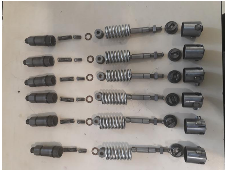
Figura 65 Elementos de bombeo
