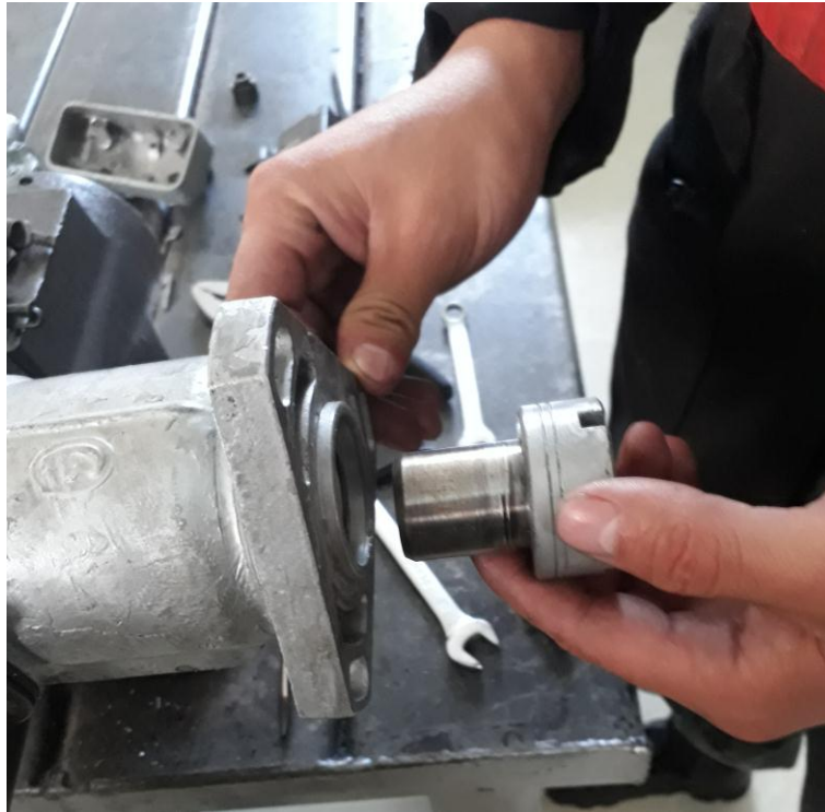
Figura 82 Extracción del eje impulsor
