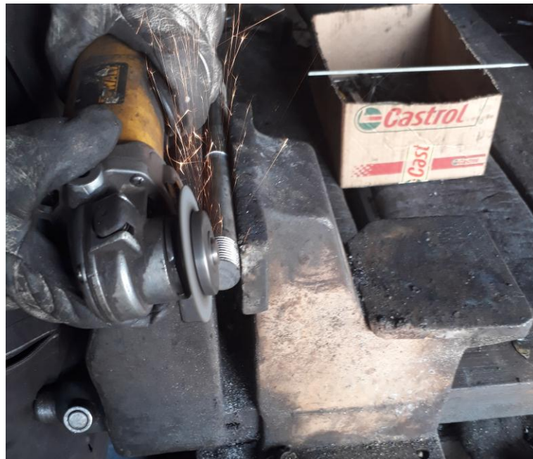
Figura 44 Corte en un extremo del eje.
