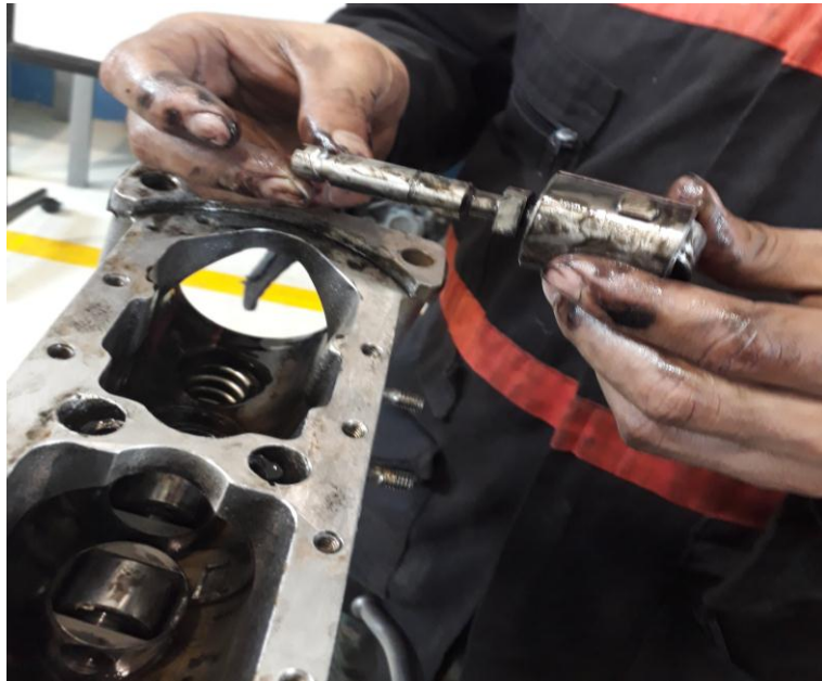
Figura 63 Elementos de bombeo
