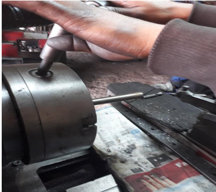
Figura 41 Montaje del eje hacer mecanizado.
