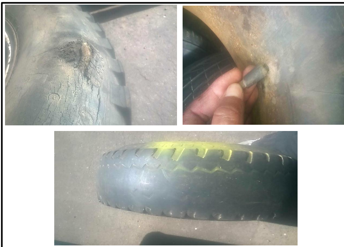
Figura 68 neumáticos de deteriorados
