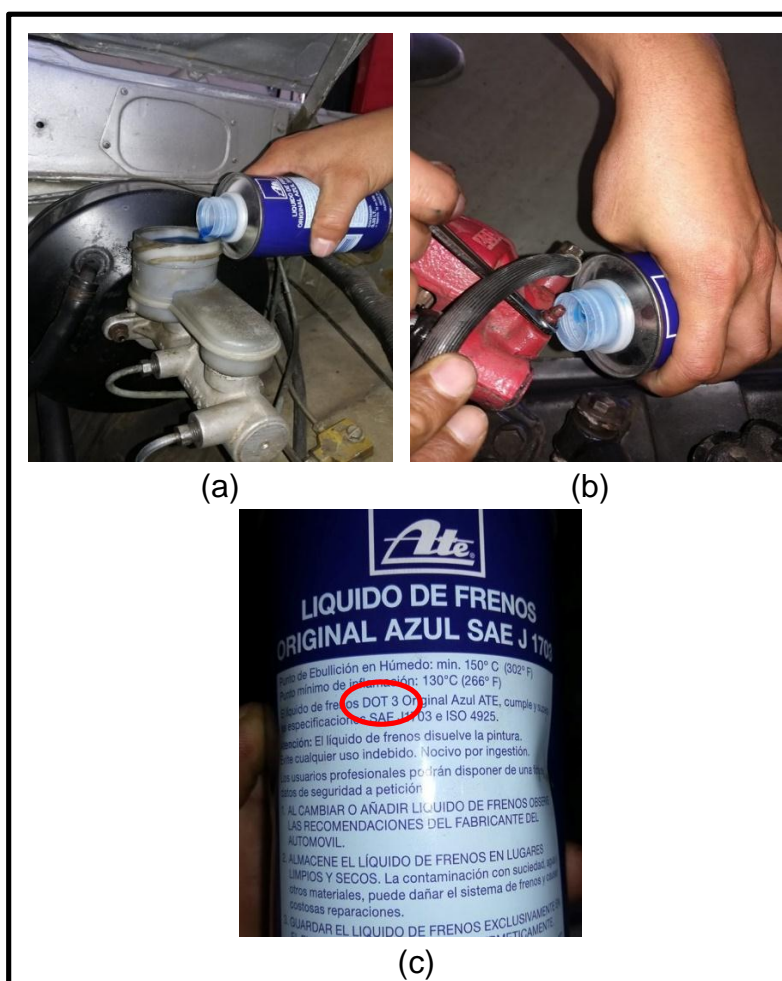
Figura 65 Sangrado del sistema de frenos Fuente: (autor de la tesis, 2018)
