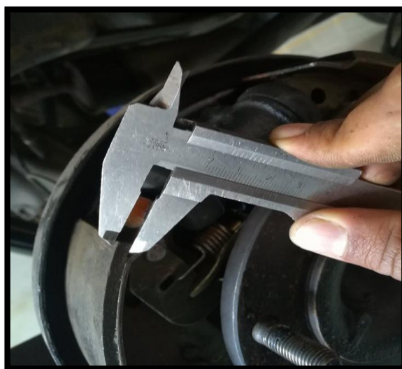
Figura 51 Medición del forro de rozamiento de las zapatas Fuente: (autor de la tesis, 2018)
