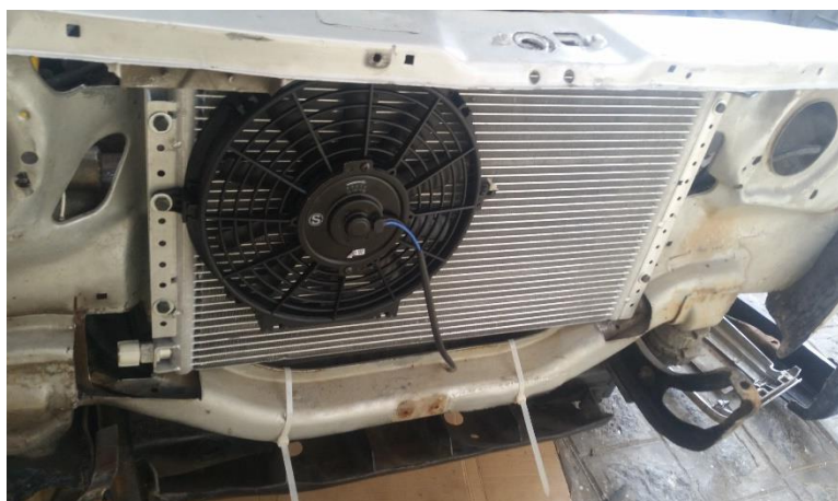
Figura 59 Instalación del condensador
