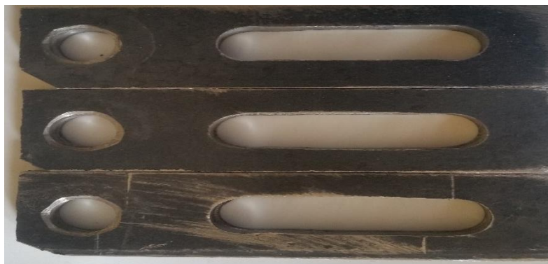
Figura 52 Soporte del compresor
