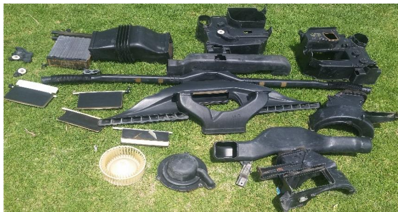
Figura 48 Ductos de calefacción y A/C
