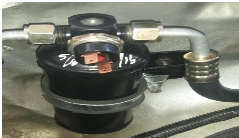
Figura 60 Instalación del acumulador deshidratador
