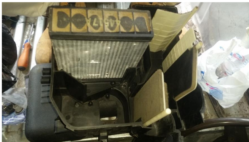
Figura 64 Instalación del radiador de calefacción
