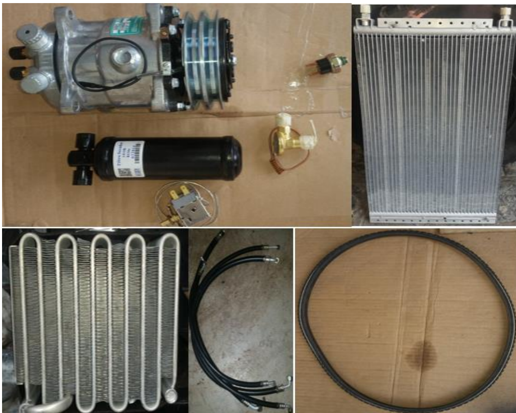
Figura 50 Componentes del sistema de A/C
