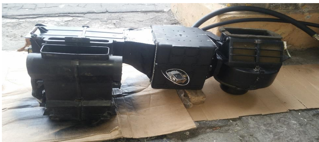
Figura 65 Instalación de la caja central de calefacción y A/C
