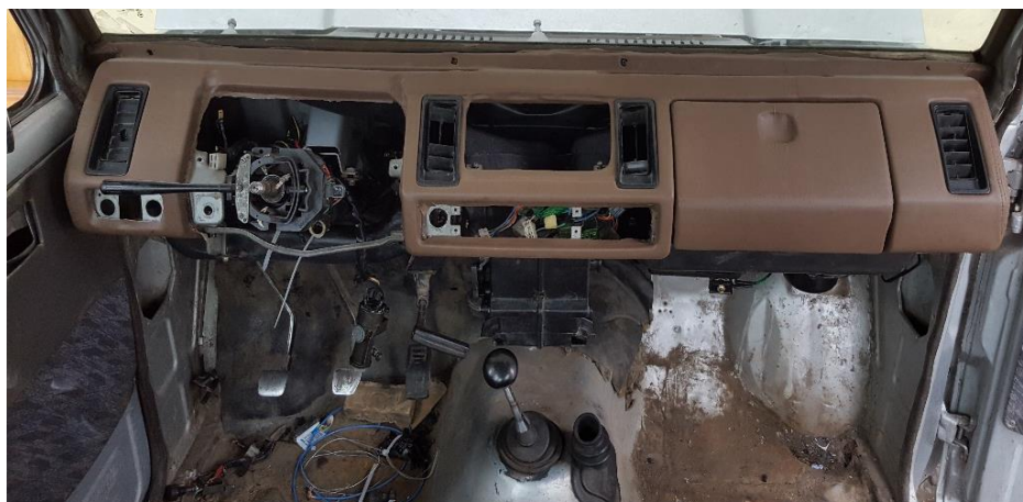
Figura 75 Instalación del tablero
