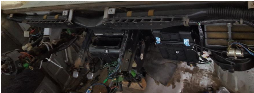
Figura 68 Sistema de calefacción y A/C completo
