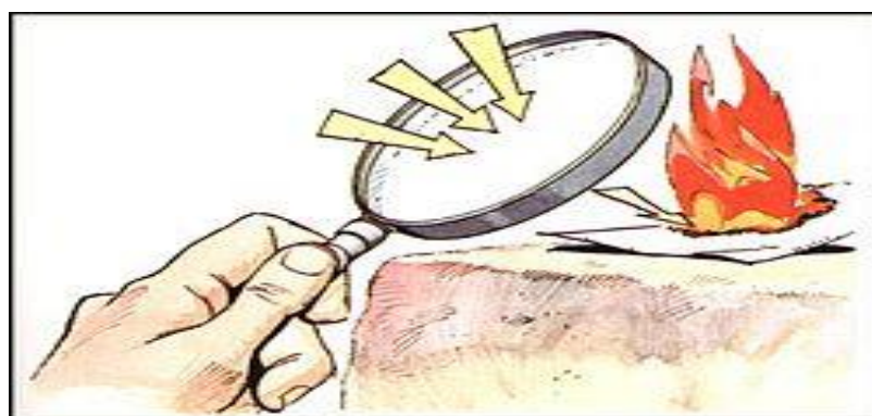
Figura 13 Transferencia de calor por radiación
