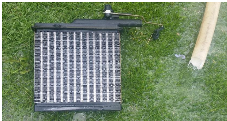
Figura 49 Comprobación del radiador de calefacción
