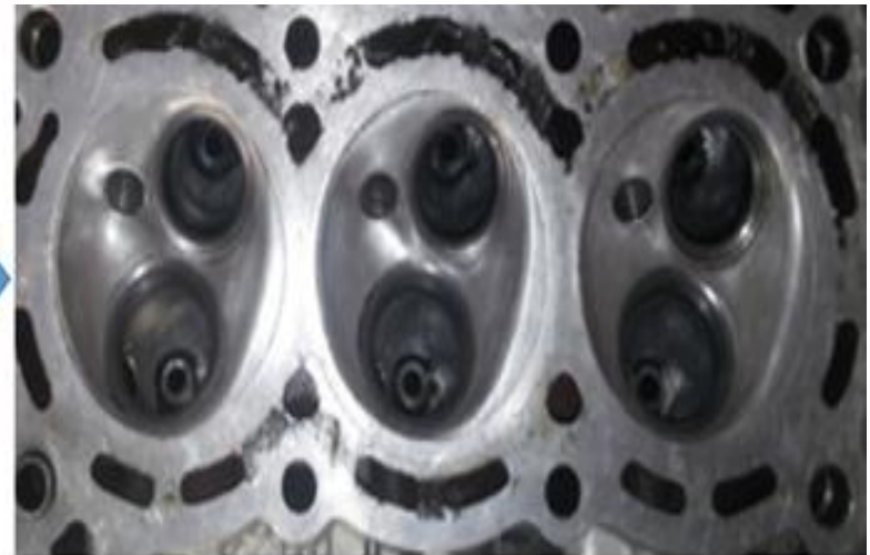
Cámaras De Combustión Limpias Y Pulidas
