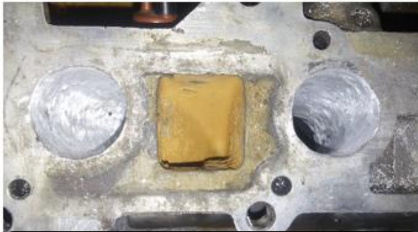
Conductos De Admisión Mecanizado Con Fresa
