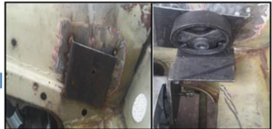
Refuerzo Carrocería, Base colocada En La Caja De Cambios
