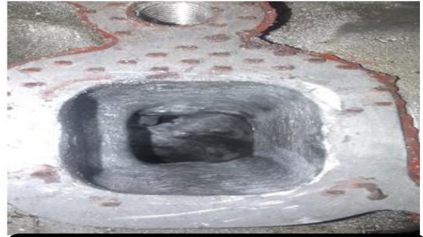
Conducto De Escape Mecanizado Con Fresa
