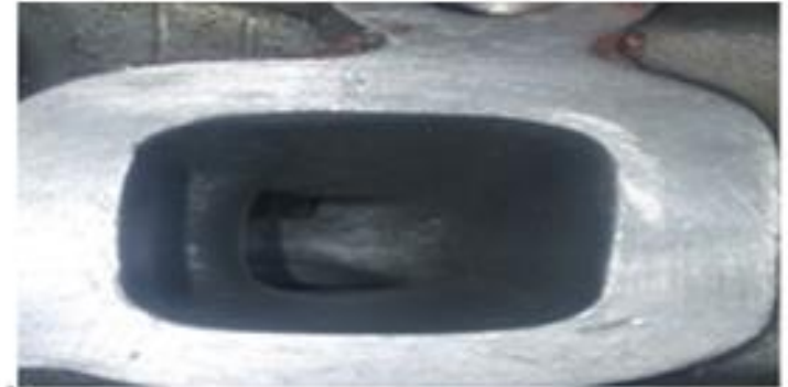
Mecanizado Conducto De Escape Con Piedras Abrasivas
