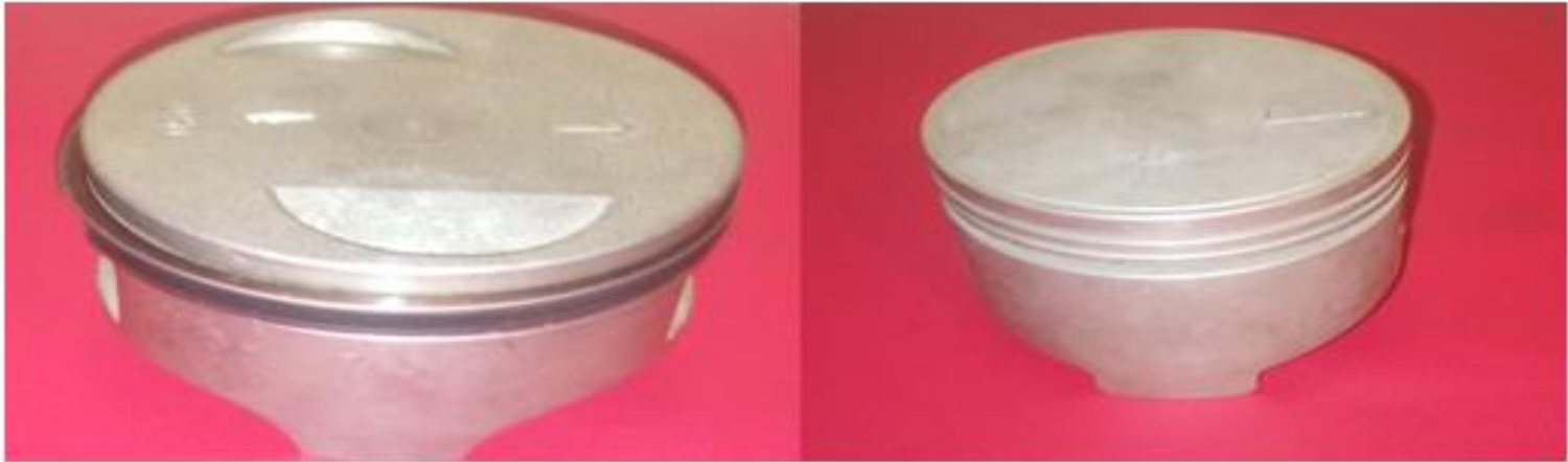
Pistón Motor G10 (Izquierda), Pistón Motor 4g15 (Derecha)
