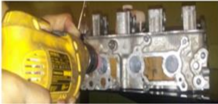
Mecanizado Conducto De Admisión Con Piedras Abrasivas
