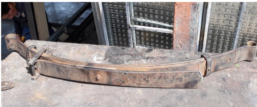
Figura 29 Ballesta antes del mantenimiento
