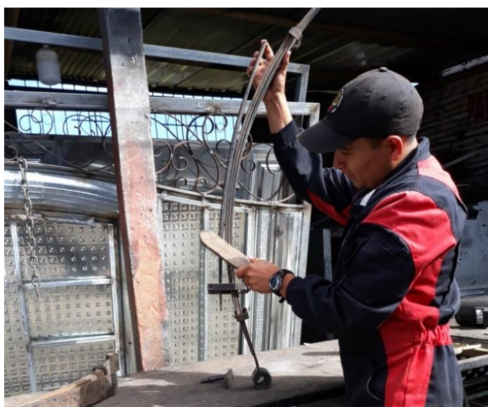
Figura 30 Limpieza de las ballestas
