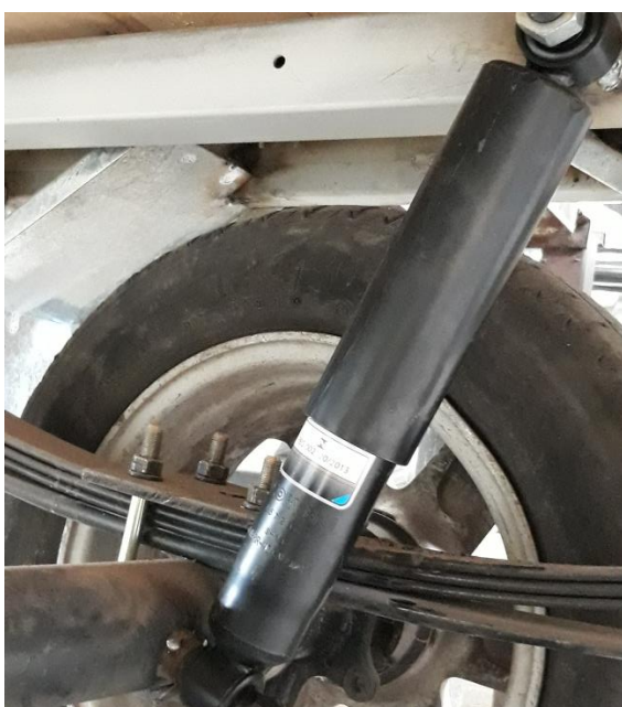
Figura 44 Montaje de los amortiguadores
