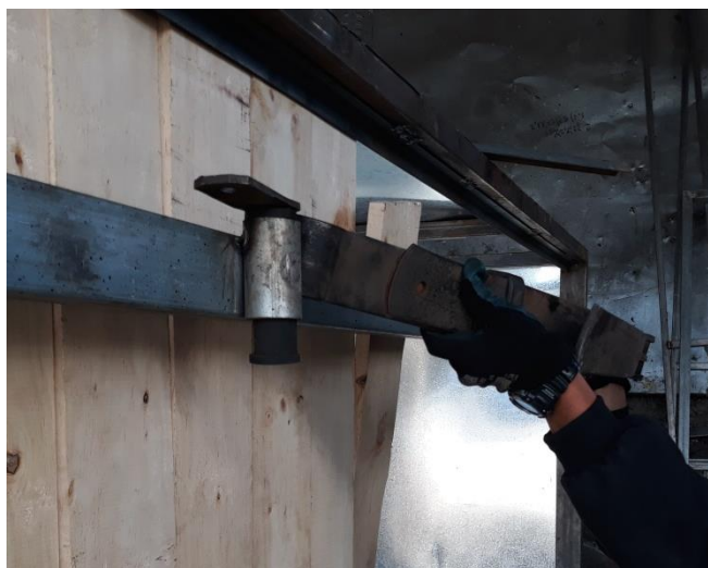
Figura 38 Montaje de ballestas
