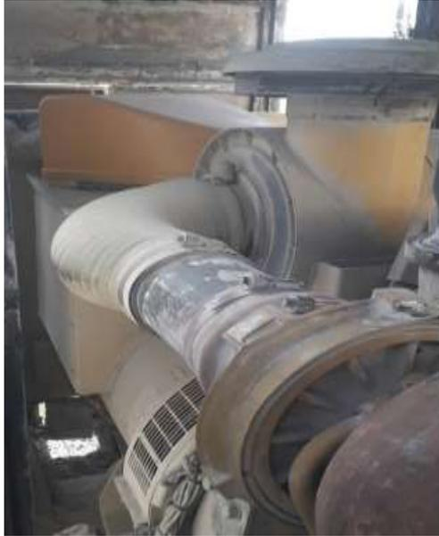
*Nota.* Parte externa del motor recubierta de cemento.
