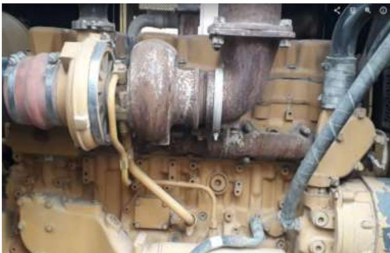
*Nota.* Presencia de óxido en tubería de escape.
