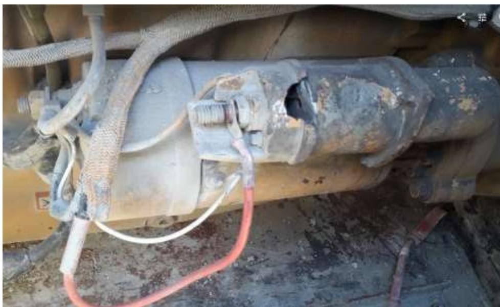
*Nota.* Motor de arranque deteriorado que no permite el funcionamiento del generador.
