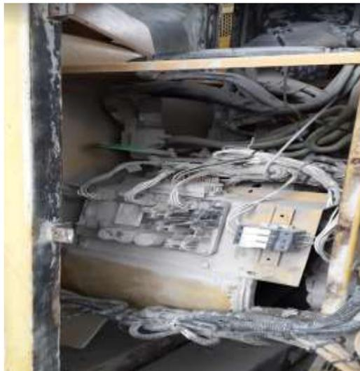
*Nota.* Bornes recubiertos de cemento y polvo
