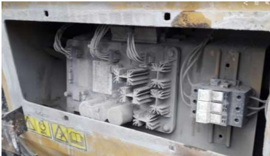
*Nota.* Recubrimiento de la parte externa del módulo de control con partículas de cemento.
