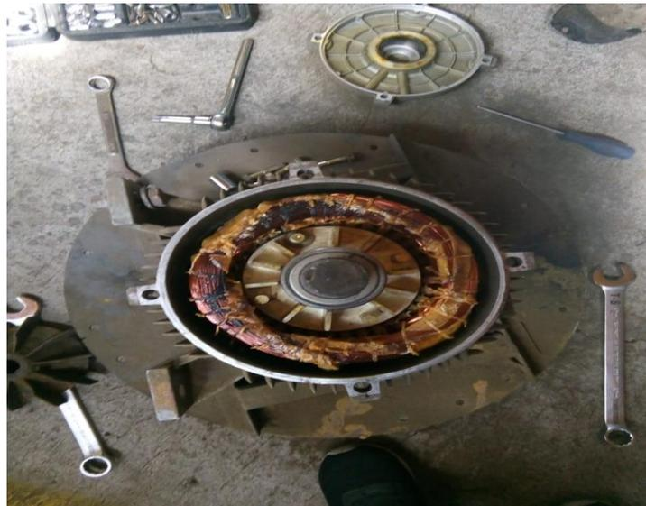
**Figura 18.** Bobina quemada del motor
