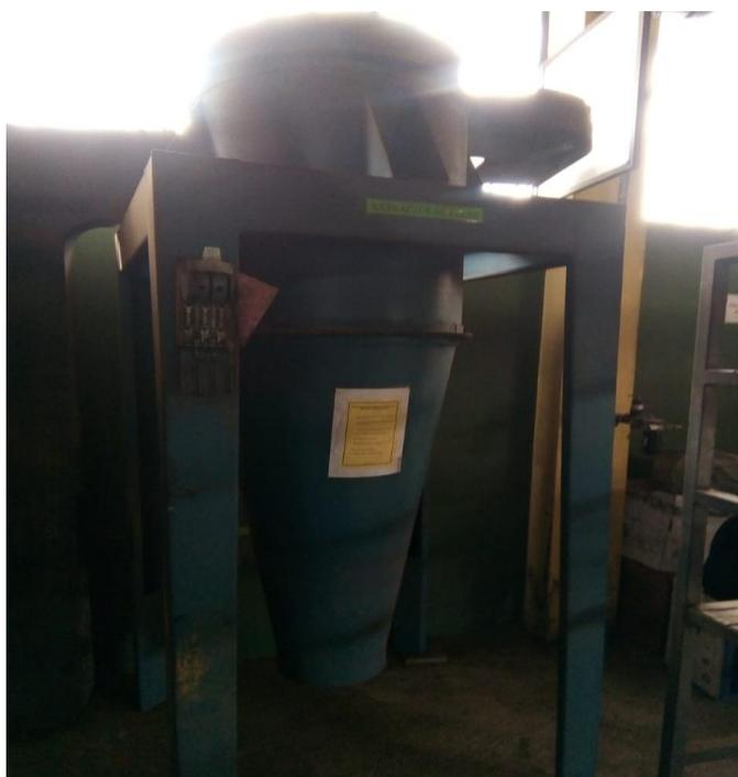
**Figura 14.** Extractor de polvo ciclón previo a la repotenciación
