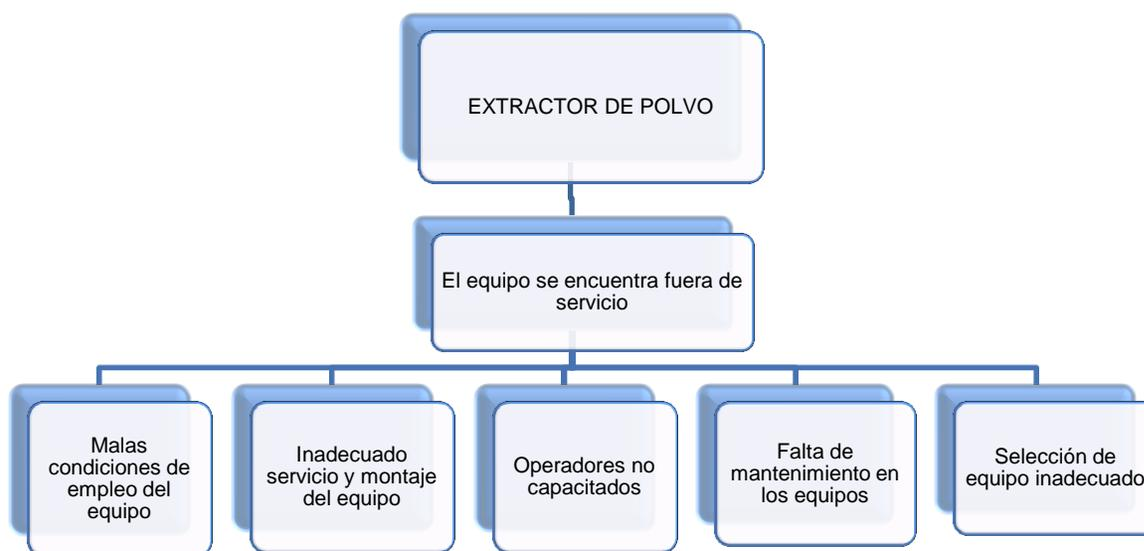
**Figura 41.** Análisis de causa raíz aplicada al extractor de polvo
