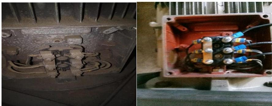
**Figura 28.** Reemplazo de bornera de conexiones
