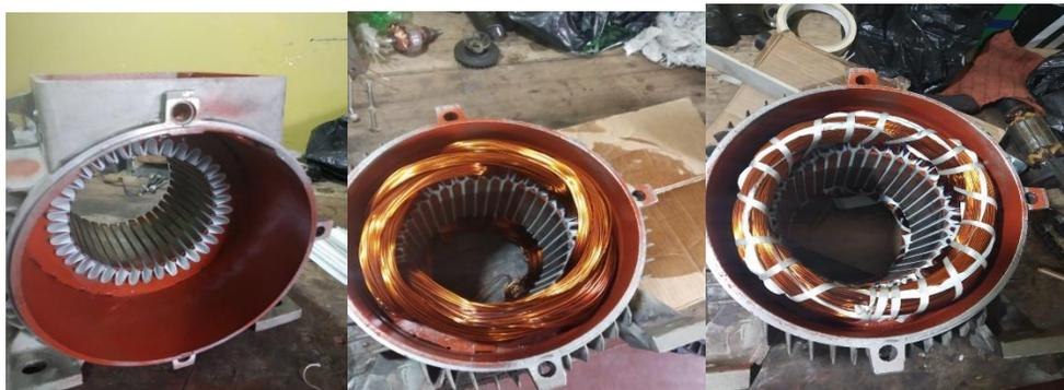
**Figura 26.** Rebobinado de una fase del motor
