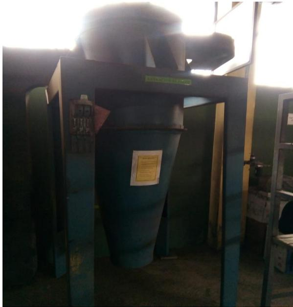
**Figura 21.** Extractor de polvo sin conexión eléctrica y sin motor
