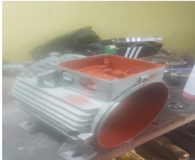
**Figura 25.** Carcasa del motor repotenciada
