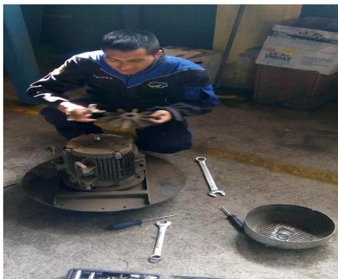
**Figura 17.** Ventilador del motor
