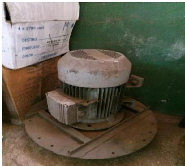
**Figura 15.** Motor eléctrico trifásico de 5 hp antes de la repotenciación
