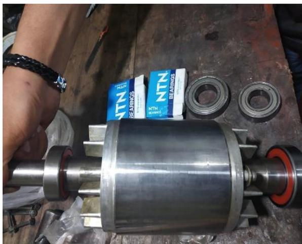
**Figura 27.** Reemplazo de rodamientos
