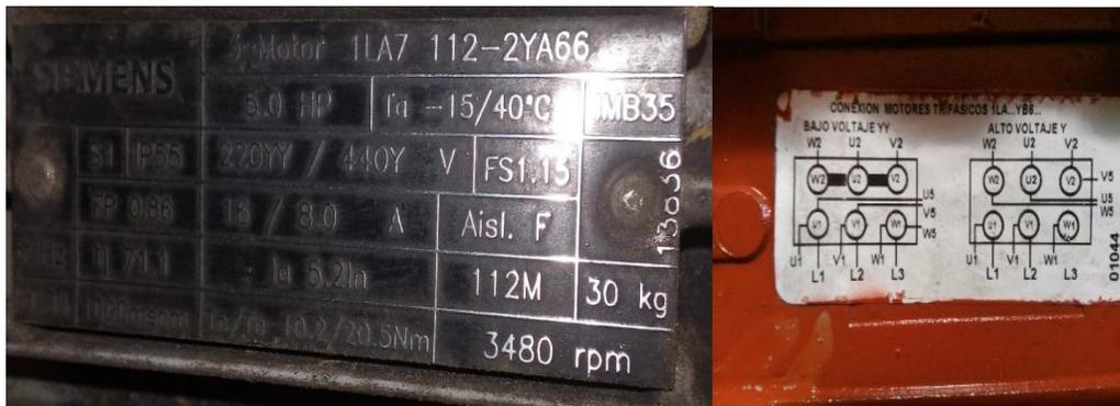
**Figura 33.** Placa de datos y conexiones del motor
