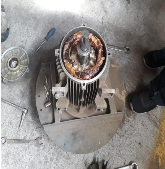
Rebobinado del motor trifásico de 5 Hp
