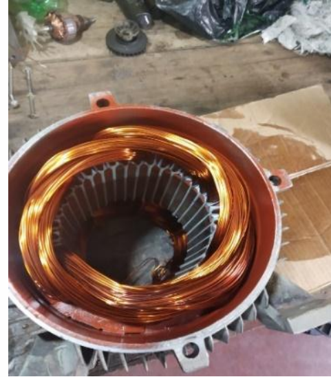
Rebobinado del motor trifásico de 5 Hp
