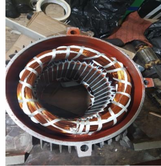
Rebobinado del motor trifásico de 5 Hp
