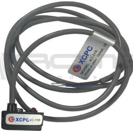
Son elementos que detectan por magnetismo la posición del vástago del cilindro, son capaces de detectar a través de la pared del cilindro sin contacto con el vástago
