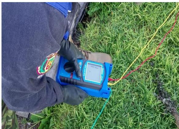
**Figura 51** Pruebas con el telurómetro.
