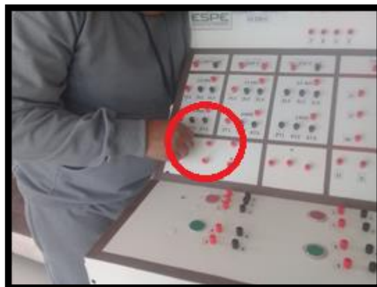
Figura 33. Colocación de jacks
