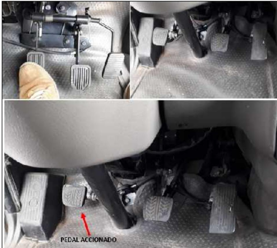
**Figura 74 Prueba del pedal de embrague**
