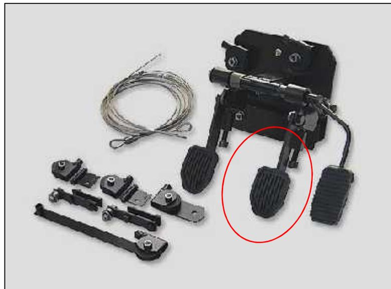
**Figura 19 Doble mando (pedal de freno)**
