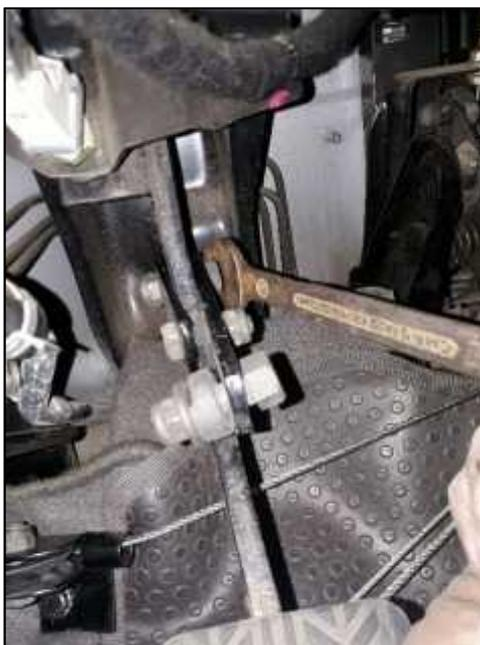
**Figura 67 Pivote del pedal de freno**
