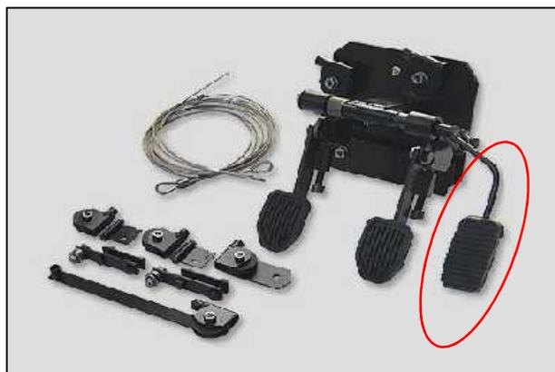
**Figura 18 Doble mando (pedal de acelerador)**
