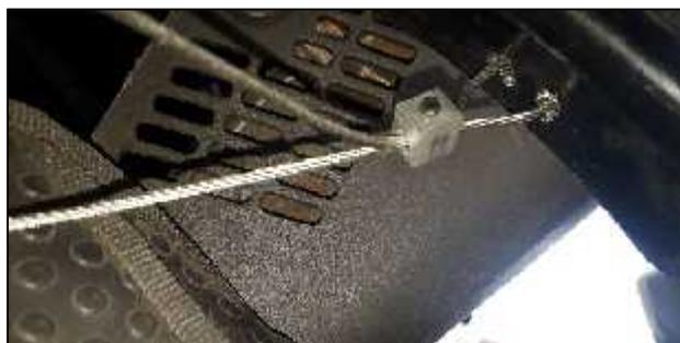
**Figura 71 Conexión del cable de acelerador**
