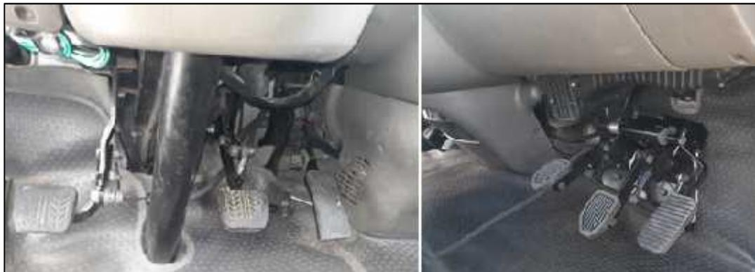
**Figura 73 Instalación del doble mando concluida**
