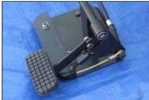
**Figura 14 Sistema doble mando tipo freno**
