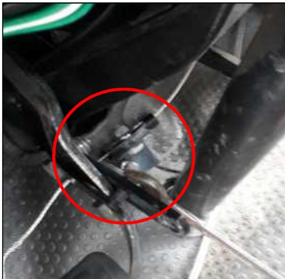
**Figura 66 Pivote del pedal de embrague**
