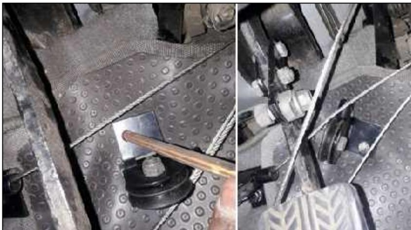
**Figura 68 Instalación de Porta Poleas de embrague y freno**
