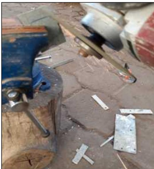
**Figura 33** Proceso de corte (acelerador)
