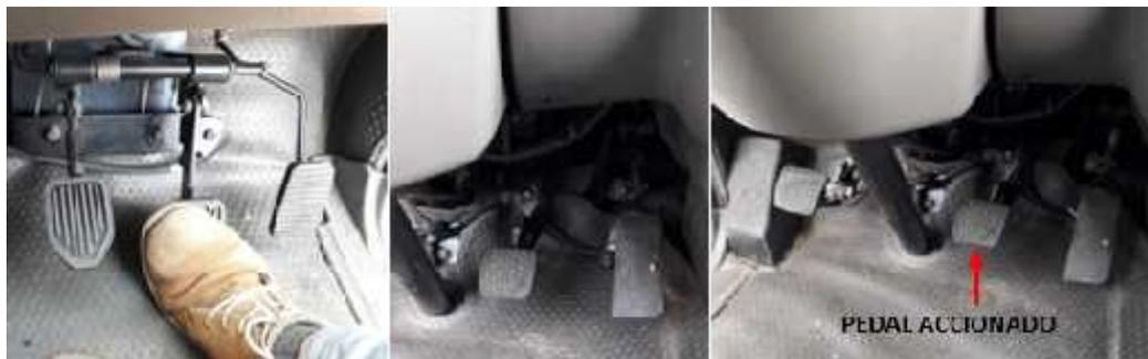
**Figura 75 Prueba del pedal de freno**
