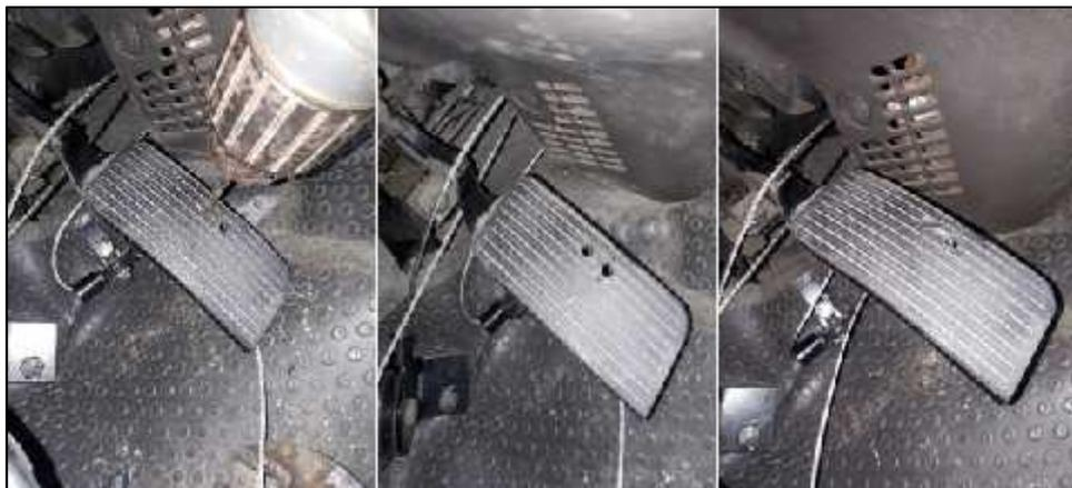
**Figura 69** Perforación del pedal de acelerador
