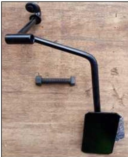
**Figura 34 Pedal del acelerador**
