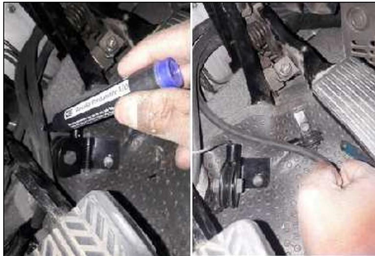
**Figura 72 Instalación de fundas protectoras de goma**
