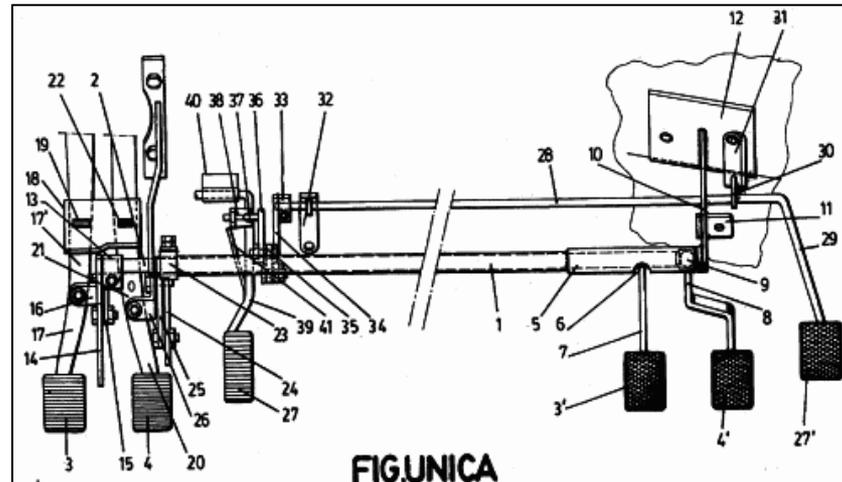
Por lo tanto, con la construcción e implementación de un sistema de doble mando para vehículos autoescuela, cuyos accionamientos son mediante cables tipos bowden y poleas, que vendrá a sustituir al varillaje que tienen los sistemas de doble mando actualmente incorporados. Permitiendo que sea una institución equipada profesionalmente, brindando clases de manejo prácticas muy bien explicadas, seguras y satisfactorias para el alumno.
