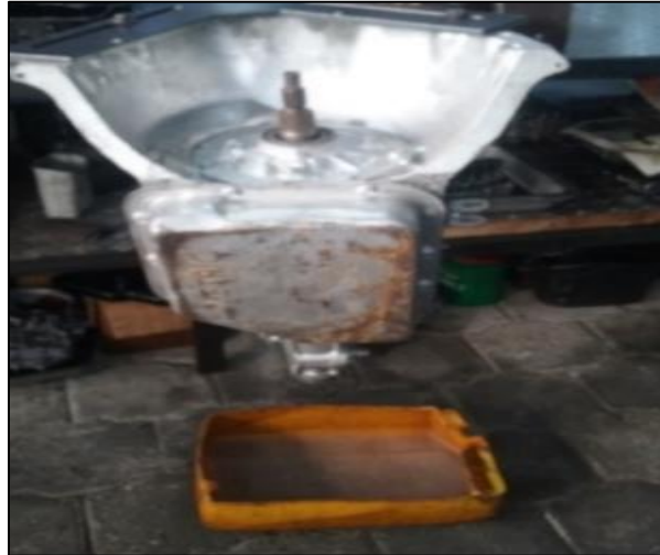
Figura 86. Drenaje del fluido.
