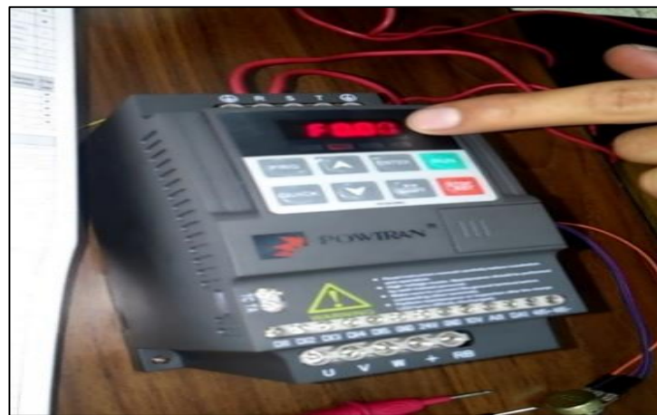
Figura 140. Programación del variador de frecuencia.
