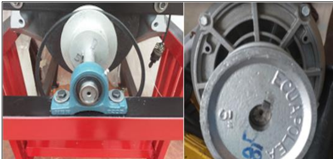
Figura 136. Poleas y banda caja de cambios- motor eléctrico.
