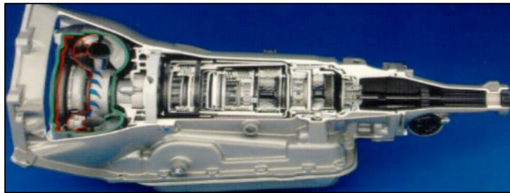
Figura 1. Vista en corte de una transmisión automática. Fuente: (Torres, 2017).
