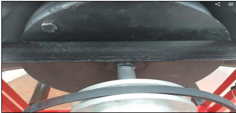
Figura 135. Platina puesta sobre el convertidor de par.
