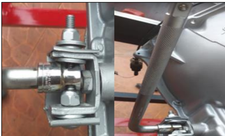
Figura 137. Adaptación palanca de cambios.
