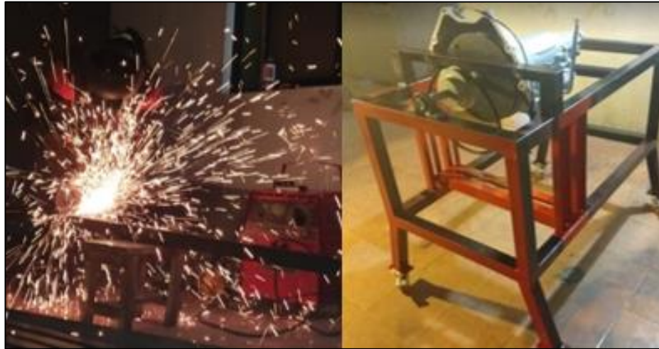
Figura 134. Construcción de la estructura del banco de simulación.
