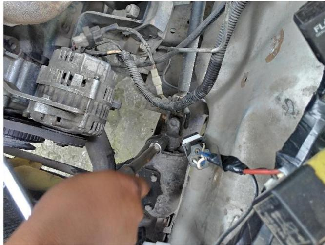
*Figura 23.*Retirando perno de columna de dirección
