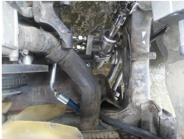
**Figura 42.** Cañerías montadas en la cremallera
