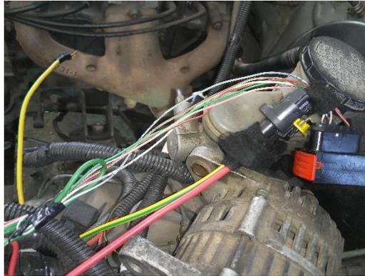
*Figura 49.* Sockets de la bomba electrohidráulica
