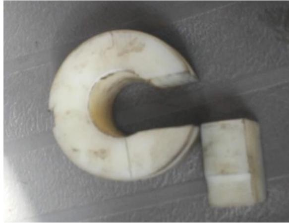
**Figura 45.** Bocín para sensor de ángulo de giro de volante
