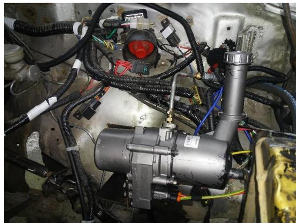
*Figura 53. Bomba del sistema electrohidráulico*
