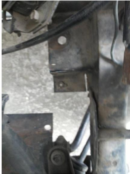
**Figura 37.** Corte de chasis para obtener espacio
