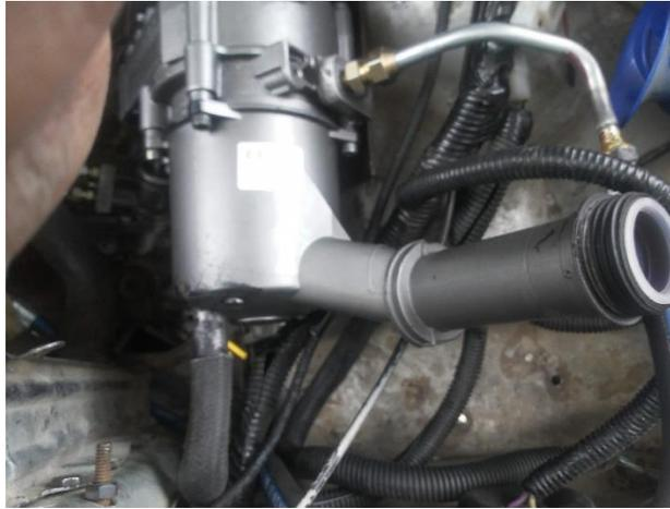
**Figura 43.** Cañerías acopladas a la bomba de dirección
