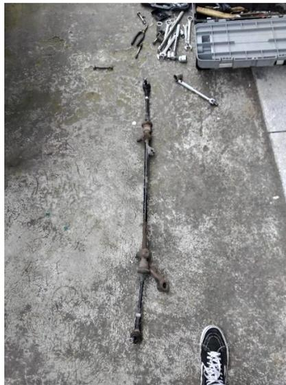
**Figura 28 .** Barras de acoplamiento desmontadas
