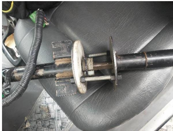
**Figura 44.** Espacio modificado para el sensor de ángulo de giro de volante
