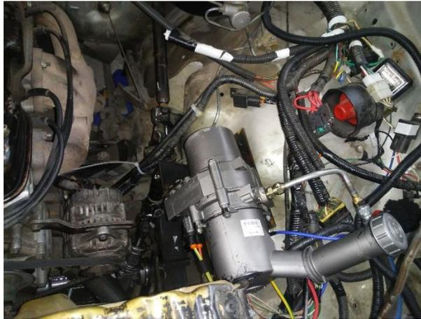
*Figura 52. Montaje de sistema de dirección electrohidráulica*
