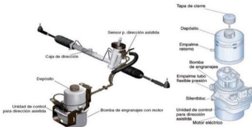
**Figura 5** .Sistema de dirección electrohidráulica
