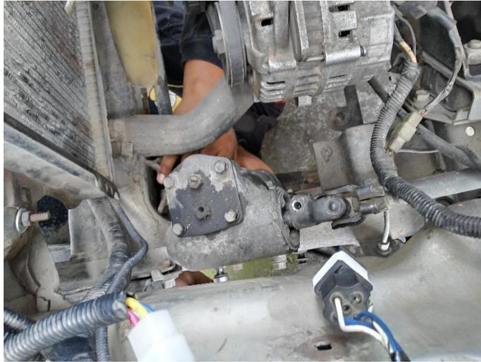
**Figura 25.** Aflojando pernos de base de caja de dirección
