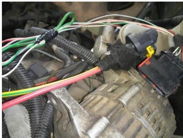
**Figura 46:** Montaje del cableado externo del vehículo
