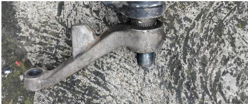
*Figura 24.*Retirando el perno del brazo de mando
