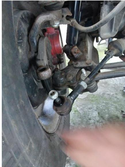
**Figura 27.** Aflojando pernos de barras de acoplamiento
