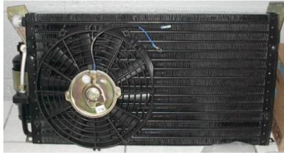
Condensador y ventilador
