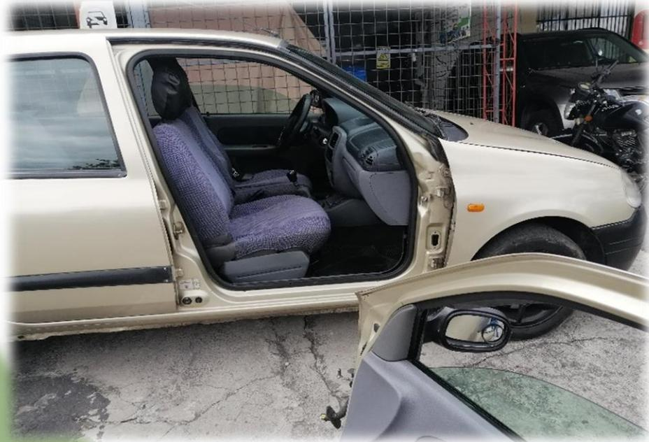
Una vez realizadas todas las modificaciones y adaptaciones para que los puntos de ensamble de anclaje del capot y puertas; se realizaron las pruebas de funcionamiento, tanto para el ensamble como desensamble de puertas y capot. En este punto cabe mencionar que, para realizar el desensamble de cualquiera de estas partes que conforman la carrocería, se lo debe hacer con el motor apagado y el vehículo estacionado en un espacio prudente para trabajar.
