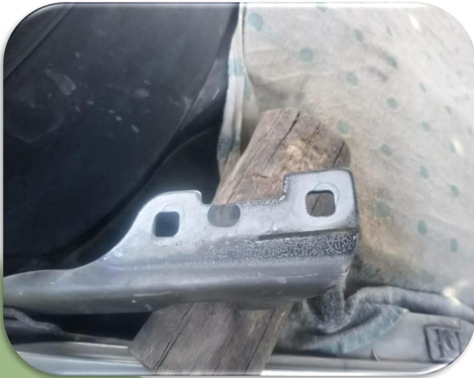
La binchas y bisagras que han sido implementadas en los mecanismos de ensamble, tanto del capot como de las puertas, fueron mecanizadas con la ayuda de herramientas manuales tales como taladro, amoladora y máquina soldadora.
