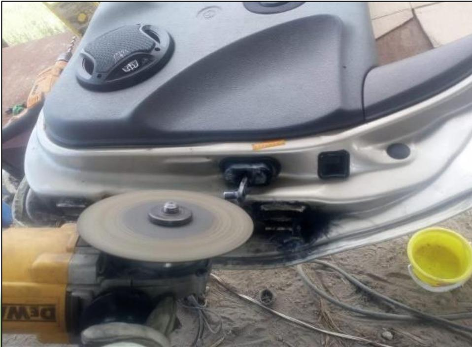
Para el caso de las puertas delanteras, el proceso fue similar, nos basamos en el mecanismo de apertura y cierre original. Aquí se tuvo en consideración la conexión y desconexión del sócalo de cables que energizan los parlantes, los mecanismos de elevavidrios y los seguros de las puertas, por tal motivo, dicho sócalo debe ser desconectado con mucho cuidado, cada vez que se necesite desmontar la/s puerta/s, para así precautelar la correcta comunicación y funcionamiento de la parte eléctrica
