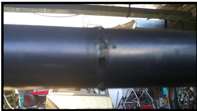
Nota: Aplicación de soldadura DE Bisel en V sencilla en estructura tubular. Tomado de: Carlos Ojeda
