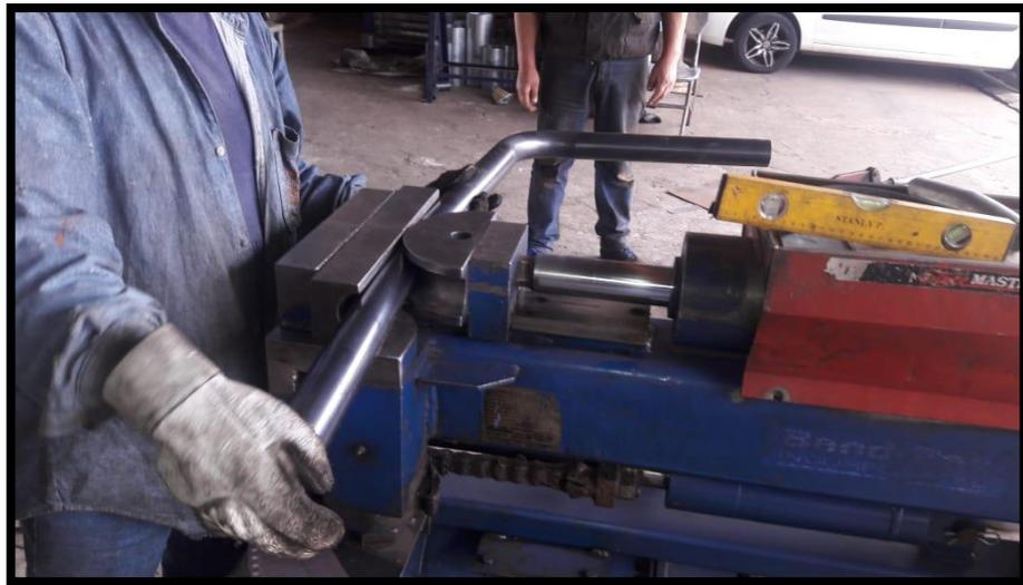
Nota: Proceso de curvatura a presión Hidráulica. Tomado de: Carlos Ojeda
