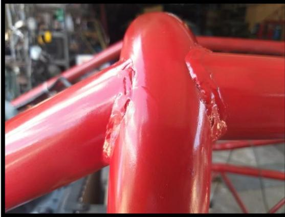
Nota: Aplicación de soldadura de Bisel con ángulo en el bastidor tubular. Tomado de: Carlos Ojeda
