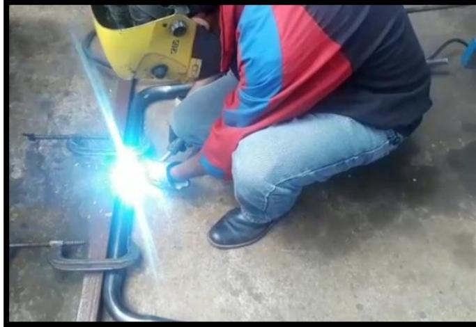
Nota: Ensamblaje de la tubería para dar forma al bastidor estructural. Tomado de: Carlos Ojeda
