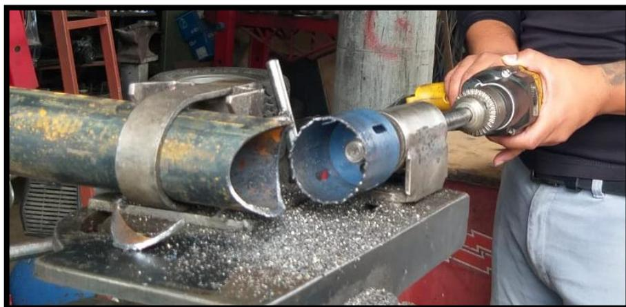
Nota: Acabado del corte circular para unión con perfil en otro tubo. Tomado de: Carlos Ojeda
