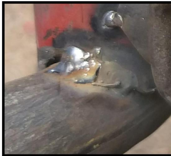
Nota: Falta de penetración provoca el espesor no deseado. Tomado de: Carlos Ojeda
