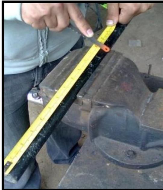
Nota: Proceso de marcado de tubo con flexómetro y rayado con sierra. Tomado de: Carlos Ojeda
