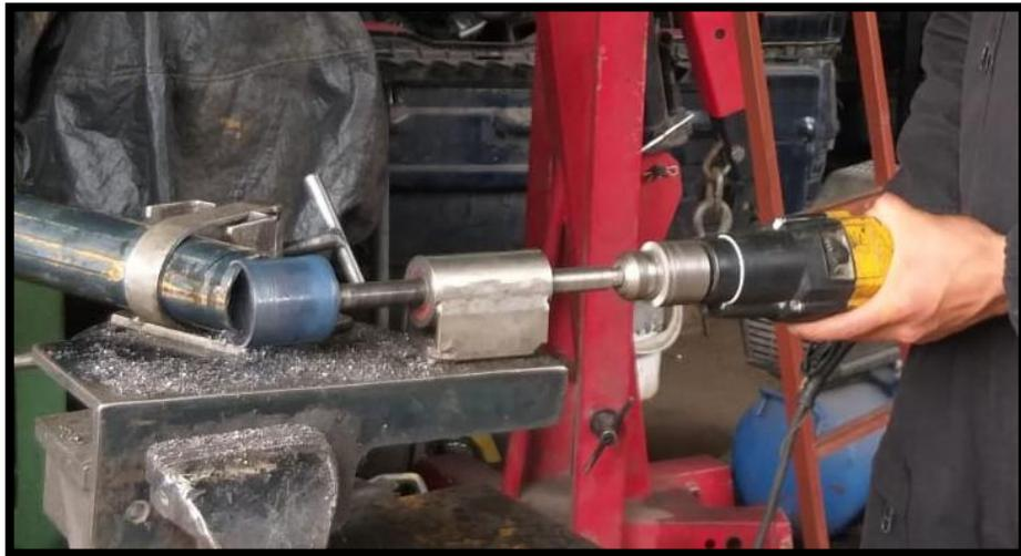
Nota: Corte circular del Tubo con taladro y acople de dientes metálico. Tomado de: Carlos Ojeda
