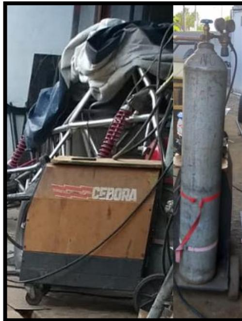
Nota: Máquina de Soldadura MIG utilizado para el ensamblaje de tubería. Tomado de: Carlos Ojeda
