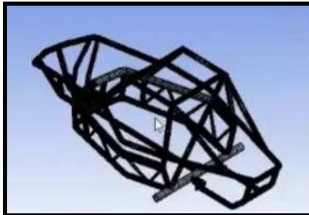
Nota: Mallado de estructura tubular para análisis de frenada. Obtenido de: Carlos Ojeda
