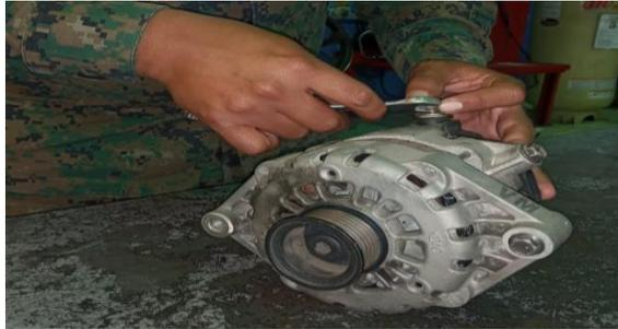
*Nota:* En la imagen se puede apreciar la extracción de la carcasa.
