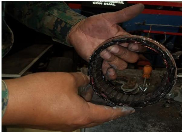
*Nota:* En la imagen se muestra una comprobación visual en el núcleo del estator.
