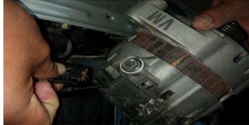
*Nota:* En la imagen se puede apreciar la desconexión del socket del alternador.
