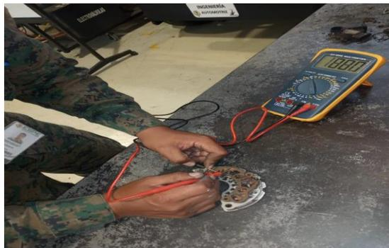
*Nota:* En la imagen se muestra la comprobación de los diodos de excitación en un puente rectificador
