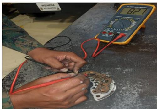
*Nota:* En la imagen se muestra la comprobación de los diodos negativos entre la fase y la salida de la carcasa del alternador.
