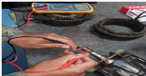
*Nota:* En la imagen se puede apreciar la inspección de los anillos rozantes.
