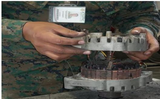
*Nota:* En la imagen se puede apreciar la separación de las carcasas.
