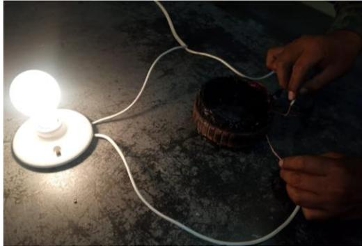
*Nota:* En la imagen se muestra la comprobación del estator unido con las fases.
