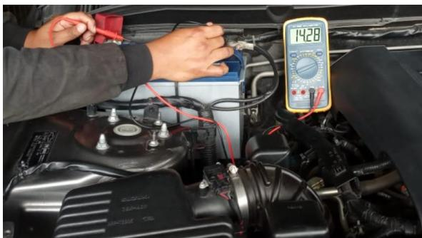
*Nota:* En la imagen se puede apreciar el valor de tensión en el alternador.
