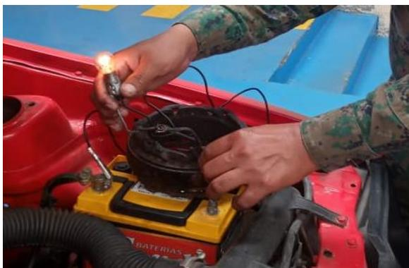
*Nota:* En la imagen se puede apreciar las pruebas que se realiza a cada una de las fases del puente de diodos que están unidas al estator.
