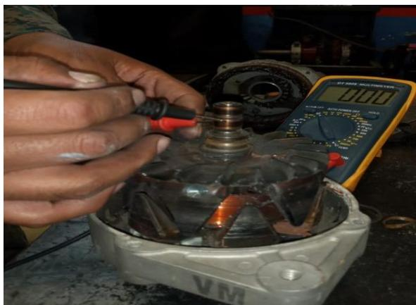
*Nota:* En la imagen se muestra la resistencia entre los anillos rozantes medidos con el multímetro.
