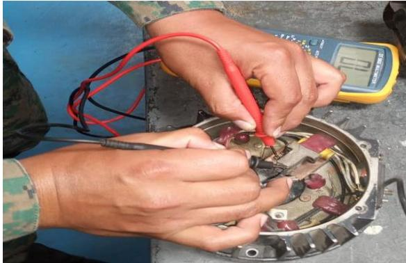
*Nota:* En la imagen se puede apreciar las pruebas hechas en el puente de diodos.
