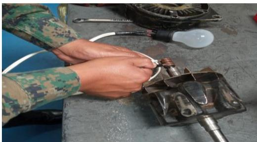
*Nota:* En la imagen se puede apreciar la prueba de continuidad en los anillos rozantes con respecto a masa.
