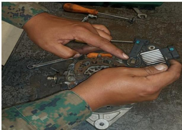
*Nota:* En la imagen se muestra la comprobación visual del porta carbones y los carbones del regulador de voltaje.
