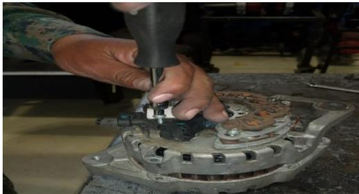
*Nota:* En la imagen se puede apreciar el desajuste del porta carbones para su extracción.
