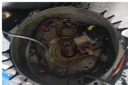
*Nota:* En la imagen se puede apreciar la inspección visual que se realiza a los carbones.
