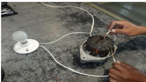
*Nota:* En la imagen se muestra la comprobación de los anillos rozantes con respecto a masa del rotor.
