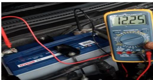
*Nota:* En la imagen se puede apreciar el valor de la tensión en la batería.
