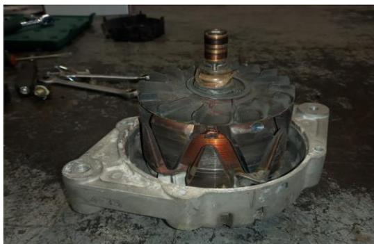
*Nota:* En la imagen se puede apreciar el rotor desacoplado de la otra carcasa.
