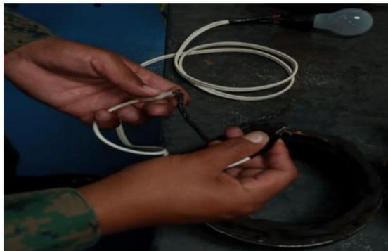
*Nota:* En la imagen se puede observar la prueba que se realiza entre la fase y el contacto a tierra del estator.
