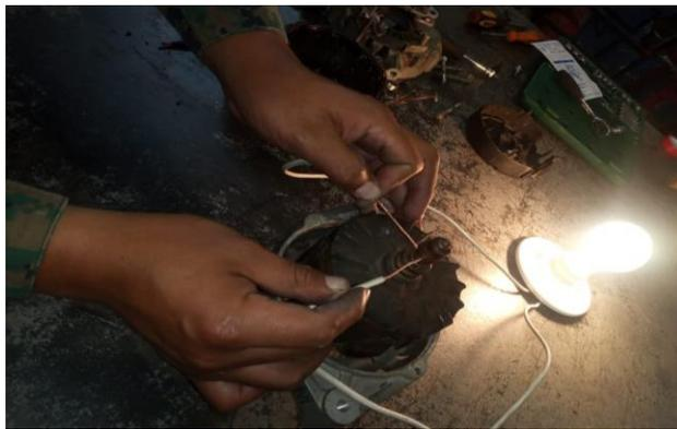
*Nota:* En la imagen se muestra la comprobación entre los anillos rozantes del rotor.
