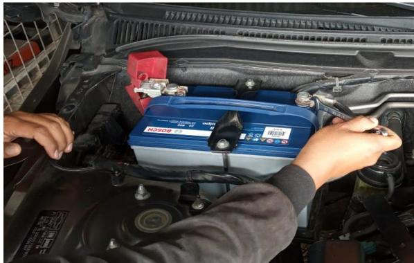
*Nota:* En la imagen se puede apreciar la separación del borne negativo de la batería.
