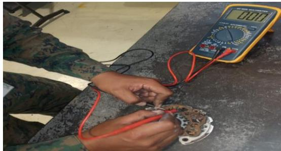
*Nota:* En la imagen se muestra la comprobación de los diodos positivos entre la fase y la salida al positivo del alternador.
