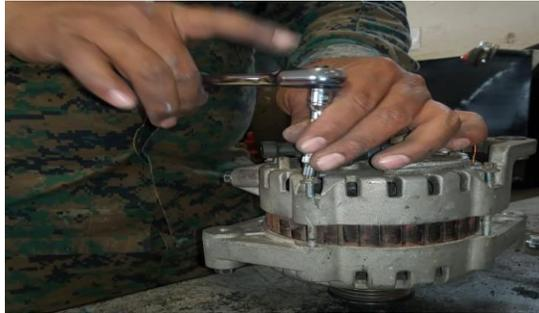
*Nota:* En la imagen se puede apreciar cómo se aflojan los tornillos de las carcasas.
