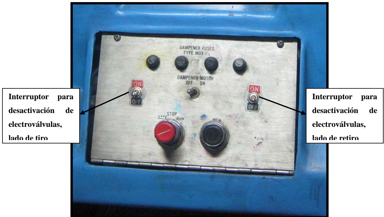
Figura. 2. 23. Panel en la parte frontal de la máquina con interruptores para desactivación de electroválvulas
