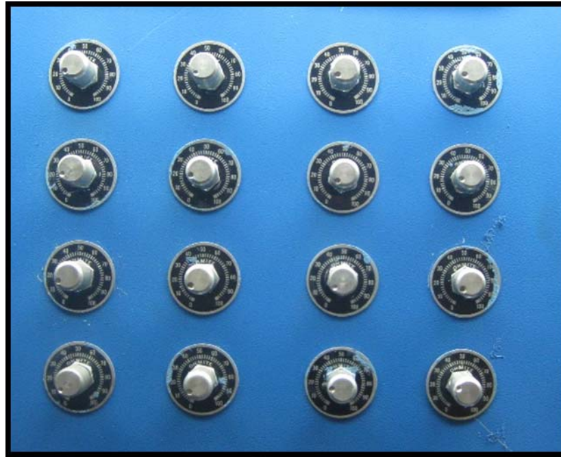
Figura. 4. 6. Potenciómetros para variar la velocidad de los motores de tinta y agua
