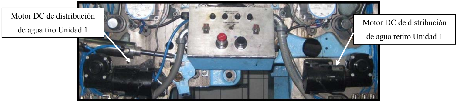
Figura. 3. 3. Fotografía de la ubicación de los motores de distribución de agua en la rotativa
