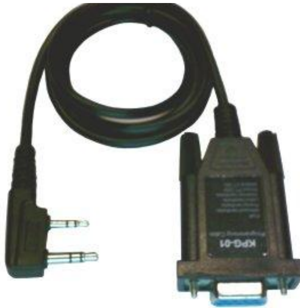
Figura 1.8 Cable de programación para el modelo KENWOOD TK 270
