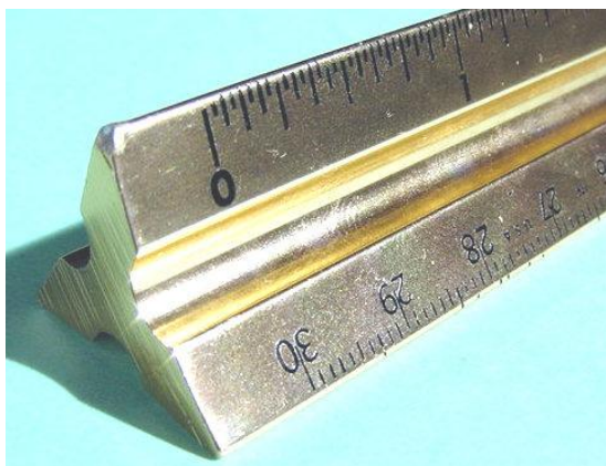
Figura 1.3 Escalímetro o escala de arquitecto, elaborado de bronce.
