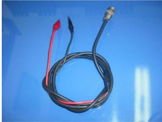
Foto. 3.31. Cable coaxial con conector y lagartos
