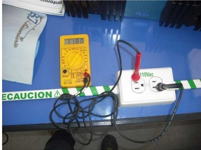
Foto. 3.33. Medición de voltaje en las mesas de trabajo
