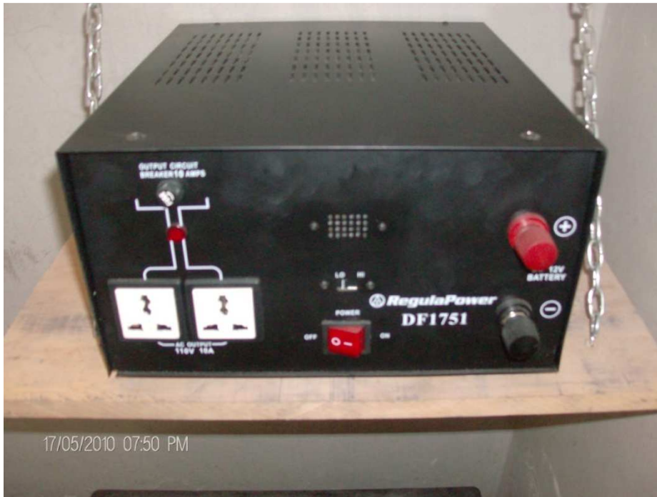
Foto 3.24 Armado y ubicación del inversor
