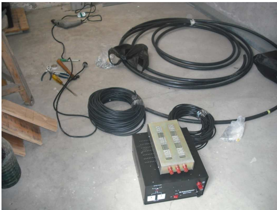
Foto 3.19 Inversor DF1751 y disipador de voltaje
