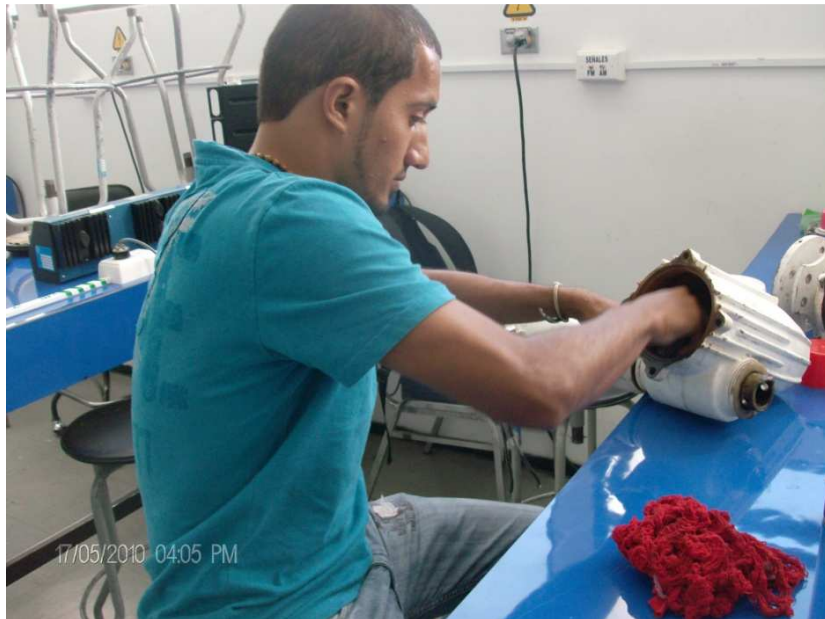
Foto 3.6 Limpieza interna del aerogenerador
