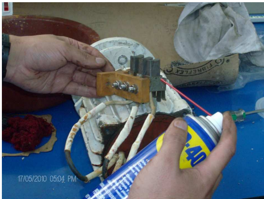
Foto 3.7 Mantenimiento de las escobillas y porta escobillas
