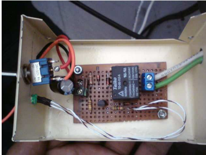
Foto 3.38 Circuito de conmutación
