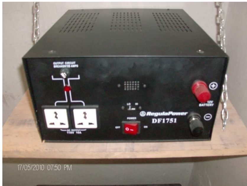
Foto 3.17 Inversor DF1751 Fuente: aerogenerador Realizado por: Julio Chasi
