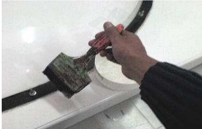
Foto 33. Chequeo de fugas de aire Elaborado por: Oscar Santiago Ortiz
