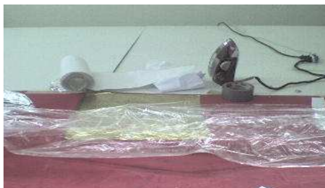
Foto 8. Unión gajos del polímero por medio de calor
