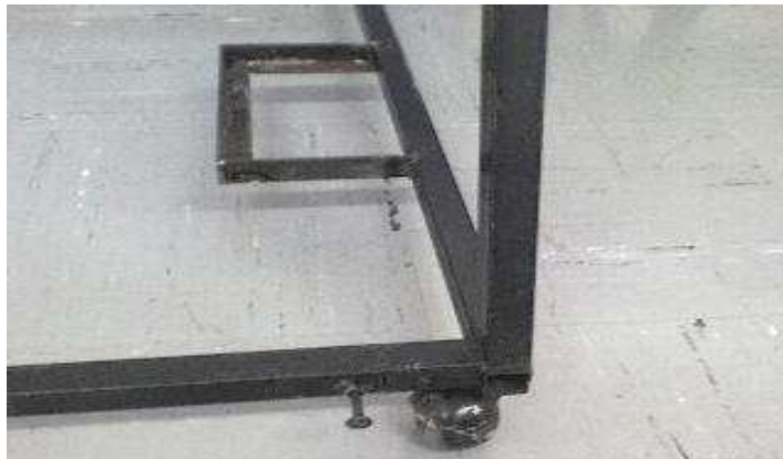
Foto 17. Garruchas y bases colocadas
