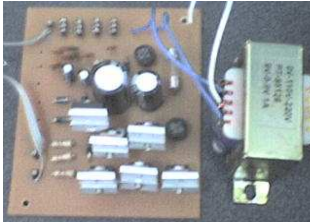
Foto 25. Elementos soldados en la placa Elaborado por: Oscar Santiago Ortiz
