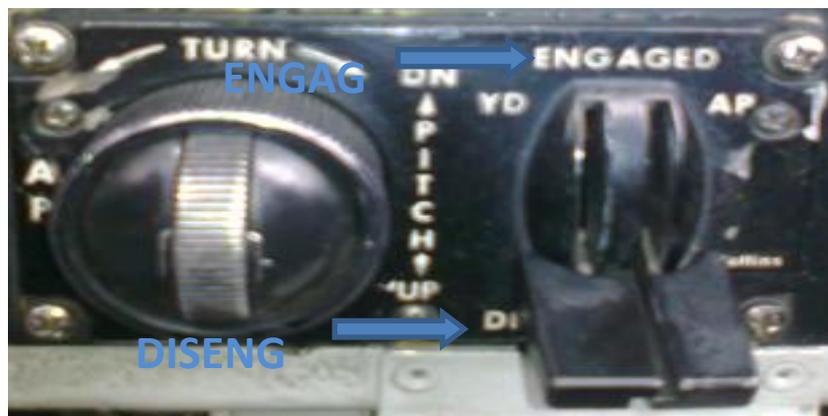
**Figura 2.7** Piloto automático engaged y desengage
