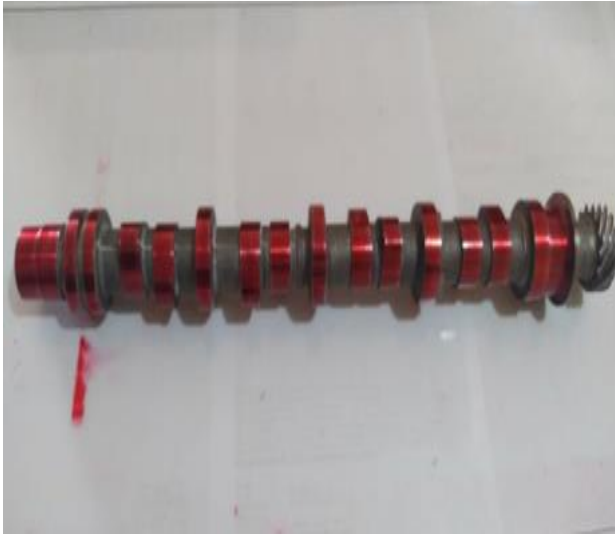
Árbol de levas con tinta penetrante
