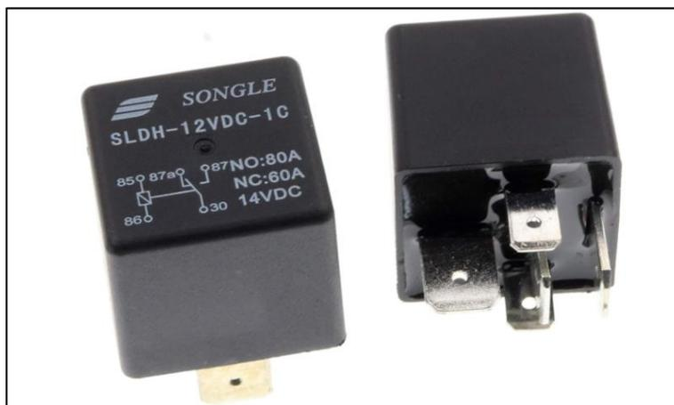
Se utilizó relés de alta potencia con el fin de controlar la activación de los módulos DC-DC, así como para tener un control del modo de gestión de la batería, es decir en su fase de carga y descarga. Las especificaciones de dichos relés se los detalla en la siguiente tabla:
