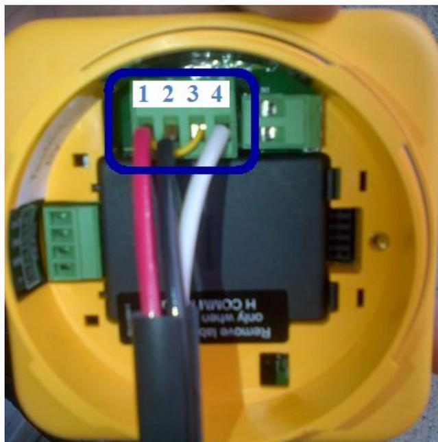
**Figura 23: Colocación de bornera en el transmisor.**
