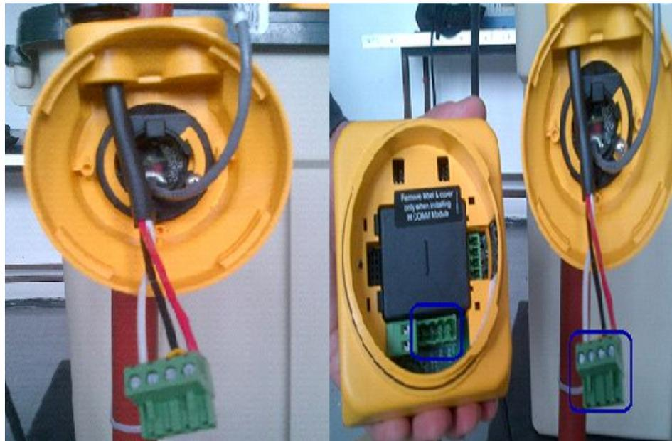
**Figura 22: Conexión para energizar el transmisor de flujo.**
