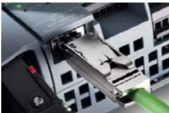
**Figura 8: Interfaz PROFINET integrada.**
