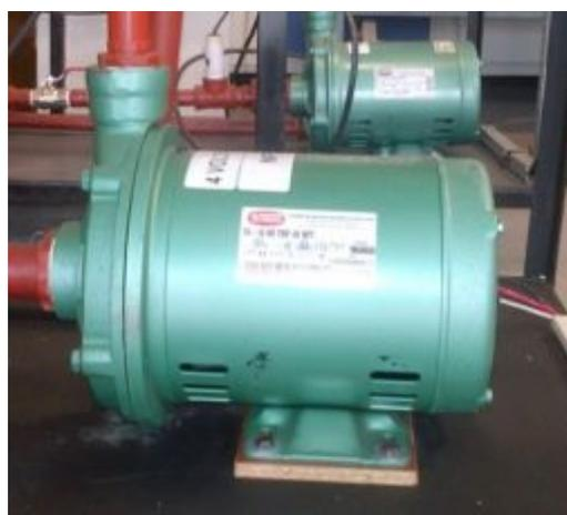
**Figura 17: Bomba centrífuga.**
