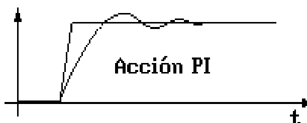
FIGURA 3: Forma de onda control proporcional integral.
