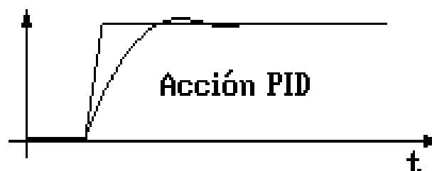
FIGURA 5: Forma de onda control proporcional integral derivativo.
