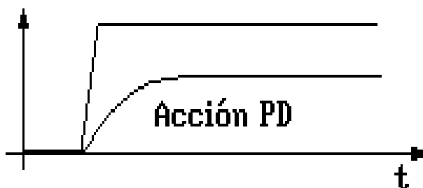
FIGURA 4: Forma de onda control proporcional derivativo.
