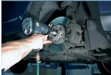
*Nota.* Paso 3 del desmontaje del semieje (GKN Driveline, 2020)
