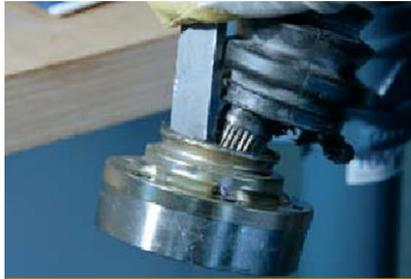
*Nota.* Paso 4 del desmontaje de la junta lado caja (GKN Driveline, 2020)
