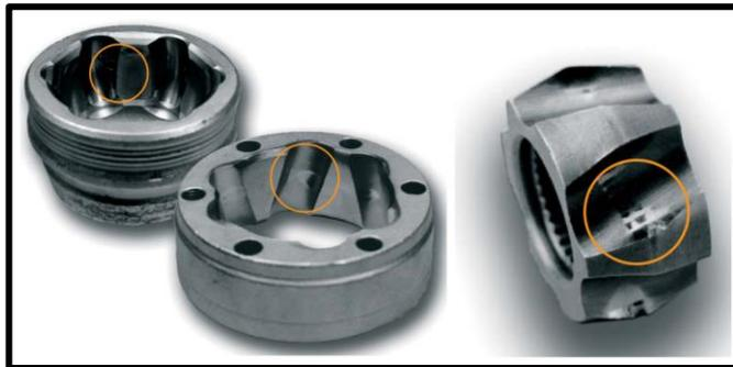
*Nota.* Se resalta los puntos con desgaste (GKN Driveline, 2020)
