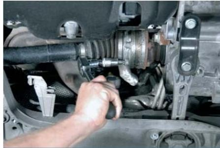
*Nota.* Paso 2 del desmontaje del semieje (GKN Driveline, 2020)
