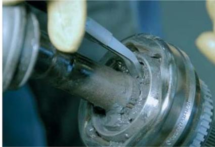
*Nota.* Paso 3 del desmontaje de la junta lado rueda (GKN Driveline, 2020)
