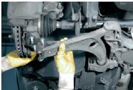
*Nota.* Paso 4 del desmontaje del semieje (GKN Driveline, 2020)
