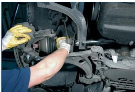
*Nota.* Paso 5 del desmontaje del semieje (GKN Driveline, 2020)
