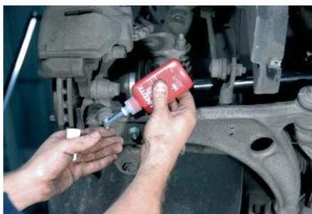
*Nota.* Paso 5 del montaje del semieje (GKN Driveline, 2020)
