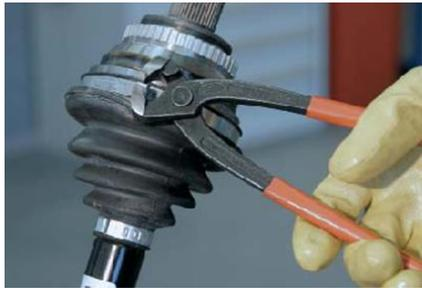
*Nota.* Paso 1 del desmontaje de la junta lado rueda (GKN Driveline, 2020)
