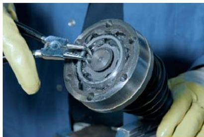
*Nota.* Paso 2 del desmontaje de la junta lado caja (GKN Driveline, 2020)
