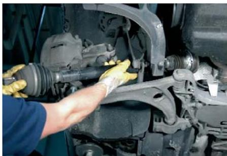
*Nota.* Paso 6 del desmontaje del semieje (GKN Driveline, 2020)
