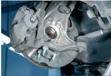
*Nota.* Paso 1 del montaje del semieje (GKN Driveline, 2020)
