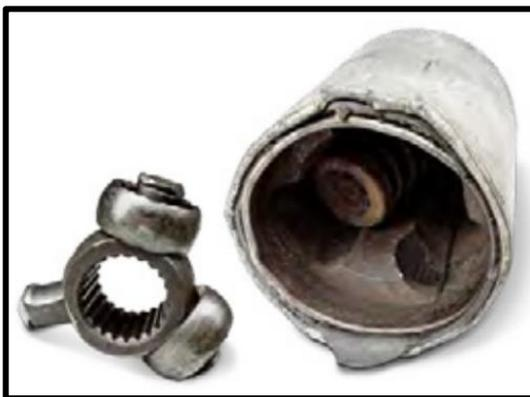
*Nota.* Junta de trípode con daños severos (WIN Autoparts, 2015)
