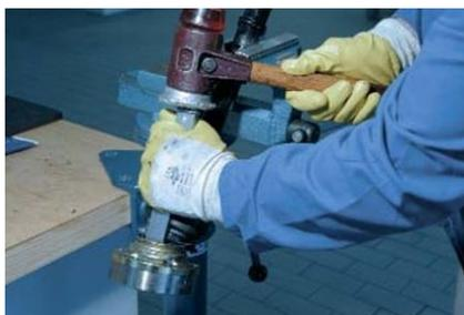
*Nota.* Paso 3 del desmontaje de la junta lado caja (GKN Driveline, 2020)
