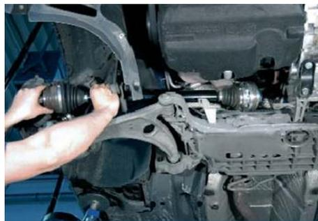
*Nota.* Paso 2 del montaje del semieje (GKN Driveline, 2020)
