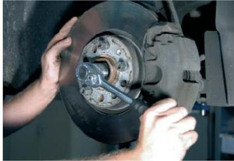
*Nota.* Paso 6 del montaje del semieje (GKN Driveline, 2020)
