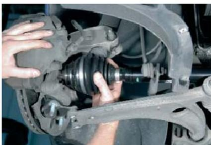
*Nota.* Paso 4 del montaje del semieje (GKN Driveline, 2020)
