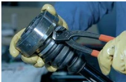
*Nota.* Paso 1 del desmontaje de la junta lado caja (GKN Driveline, 2020)
