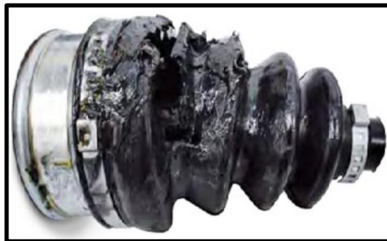
*Nota.* Un daño así, comprometería seriamente la lubricación de la junta (WIN Autoparts, 2015)
