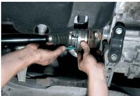
*Nota.* Paso 3 del montaje del semieje (GKN Driveline, 2020)
