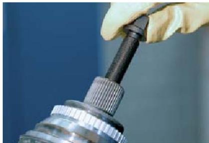
*Nota.* Paso 4 del desmontaje de la junta lado rueda (GKN Driveline, 2020)
