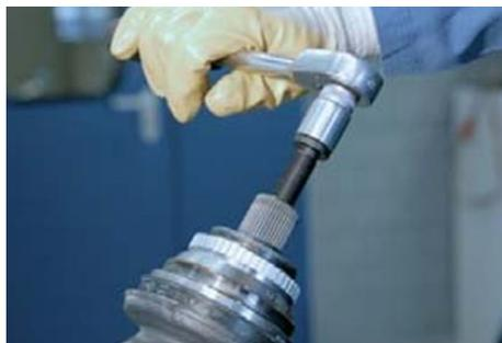
*Nota.* Paso 5 del desmontaje de la junta lado rueda (GKN Driveline, 2020)
