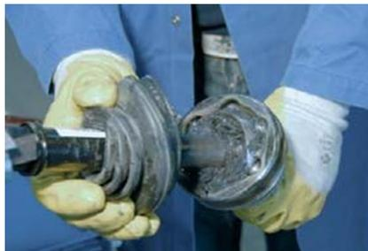
*Nota.* Paso 2 del desmontaje de la junta lado rueda (GKN Driveline, 2020)
