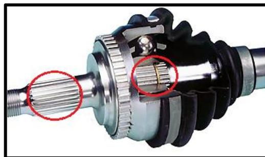
*Nota.* Se resalta el estriado del eje y de la junta (ing.unlp.edu.ar)
