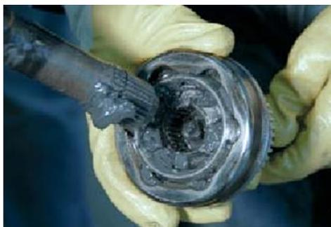
*Nota.* Paso 6 del desmontaje de la junta lado rueda (GKN Driveline, 2020)
