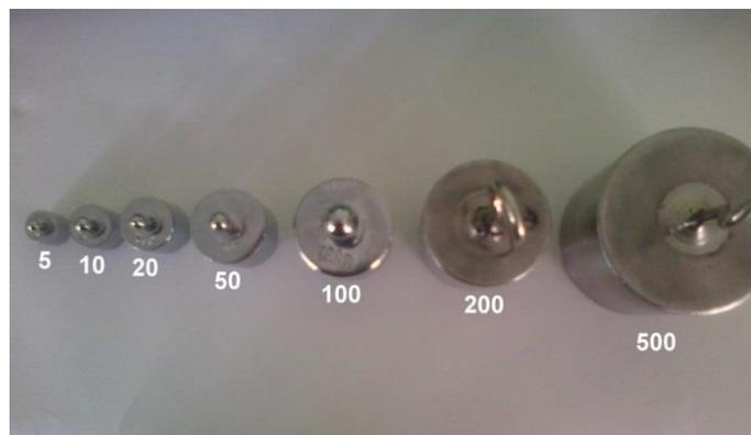
**Figura 25.** Pesas patrón para la comprobación de la celda de carga.
