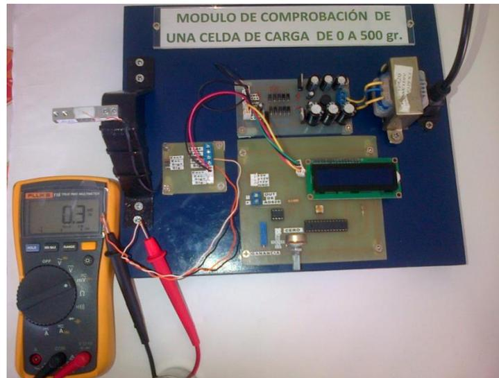
**Figura 24.** Prueba del funcionamiento de la celda de carga.
