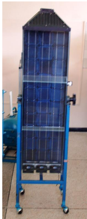
Figura 2.16. Panel fotovoltaico de 43 Wp con enfriamiento por aire.
