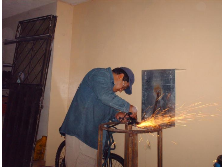
Figura 4.2. Pulido de rebabas del soporte.
