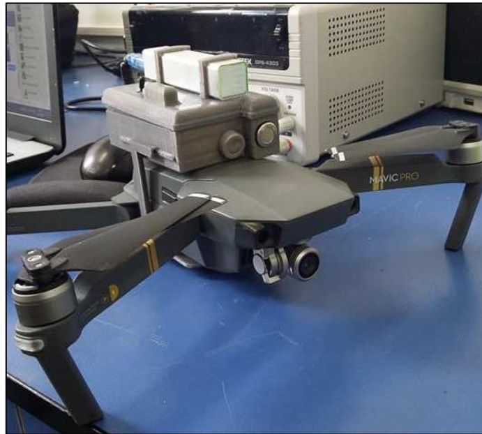
FIGURA 108: Montaje del compartimento del circuito en la parte superior del Dron (DJI Mavic PRO)
