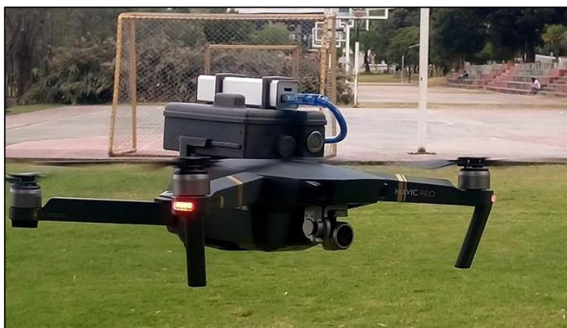
FIGURA 109: Dron (DJI Mavic PRO) en vuelo realizando mediciones de CO y CO 2
