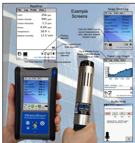
FIGURA 113: Equipo de monitoreo de Gases Tóxicos ASTOX-ST marca GRAYWOLF
