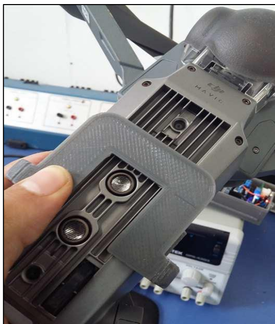
FIGURA 107: Montaje del compartimento en la parte inferior del Dron
