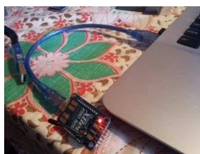
FIGURA 47: XBee PRO S2 (Coordinador) conectada mediante XBee.
