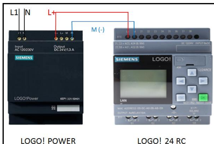
Figura 21. Conexión de LOGO! Power con LOGO! 24RC.
