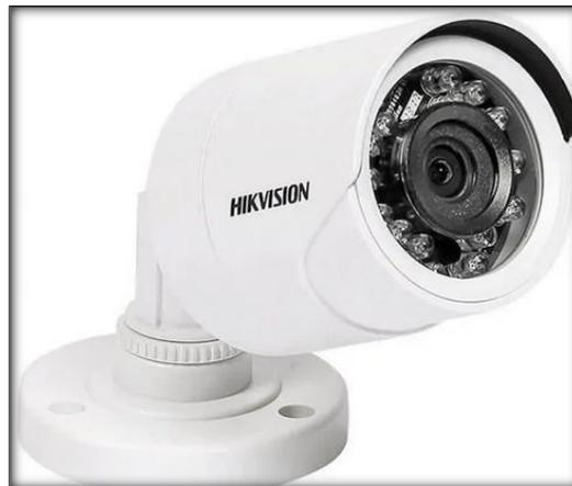
*Nota.* La Figura muestra la cámara tipo Bullet. Tomado de (ProductosIntegral, 2018)
