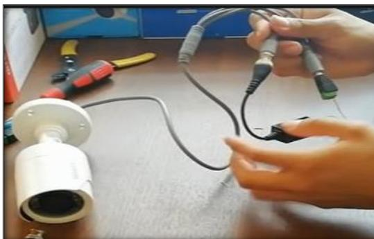
*Nota.* La figura muestra la instalación de la cámara.
