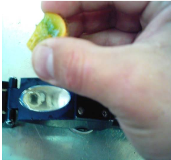
Figura 18. Extracción del jugo (gotas) para medición de sólidos solubles en Brixómetro.
