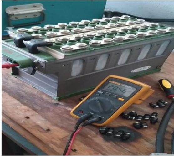
Nota: La figura se presenta la comprobación de carga de la batería a través de un voltímetro.
