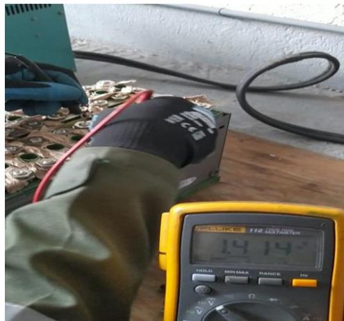
Nota: La imagen indica el voltaje medido a la salida de cada celda de la batería.
