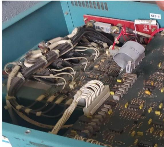
*Nota:* La imagen representa la verificación de las abrazaderas en el cableado, que no se encuentren con torceduras y tampoco con tanta tensión en sus conectores.
