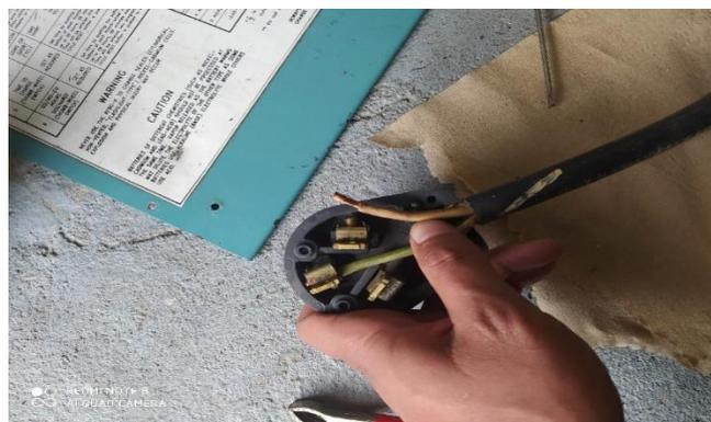
*Nota:* La gráfica indica el procedimiento desarrollado para la conexión del cable suelto de la alimentación del cargador/analizador.
