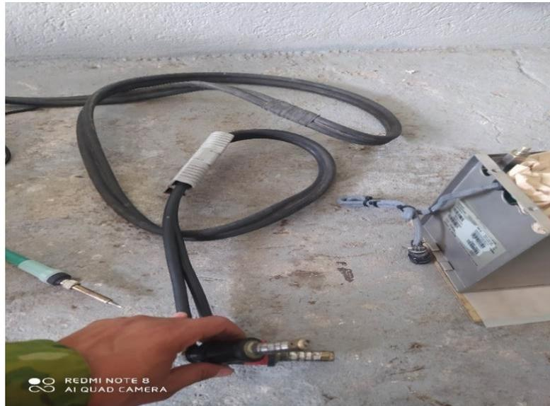
*Nota:* En la figura se visualizan los terminales de conexión del cargador de baterías.
