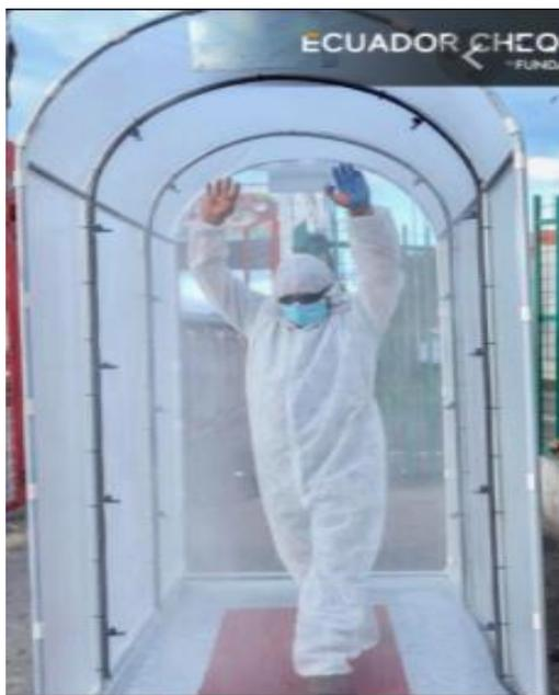
*Nota:* la imagen muestra claramente un túnel de desinfección con sus respectivas boquillas nebulizadoras en el centro las cuales atomizan el desinfectante. Tomado de (Signatory, 2020)
