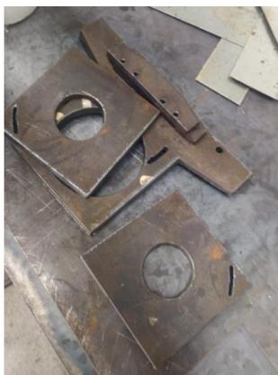
Una vez realizado las placas de soporte el siguiente paso es maquinar las placas de soporte de los tubos de tendido, el objetivo de esta placa es sostener a los tubos que van a
