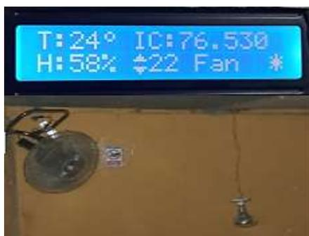
*Nota:* La figura muestra el control de temperatura y humedad en el rango de 22 si sobrepasa se activa la ventilación.
