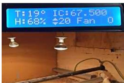
*Nota:* En la figura se muestra el control de temperatura y humedad en el rango de 20 si es menor se activan los focos.
