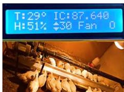
*Nota:* En la figura se muestra el control de temperatura y humedad en el rango de 30 si es menor se activan los focos.
