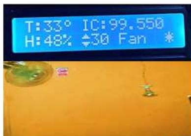
*Nota:* La figura muestra el control de temperatura y humedad en el rango de 30 si sobrepasa se activa la ventilación.
