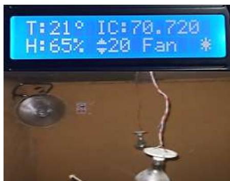
*Nota:* La figura muestra el control de temperatura y humedad en el rango de 20 si sobrepasa se activa la ventilación.
