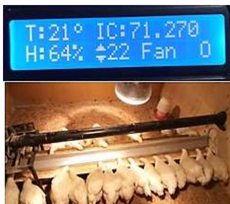
*Nota:* En la figura se muestra el control de temperatura y humedad en el rango de 22 si es menor se activan los focos.
