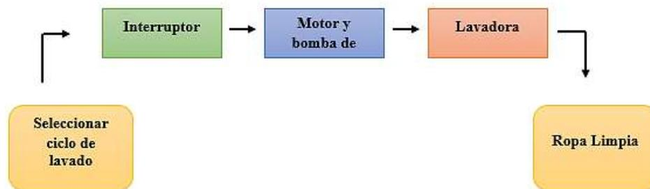
*Nota:* En la figura se muestra la representación de un sistema de control de lazo abierto de una lavadora. (Mario Alberto Perez, 2007)
