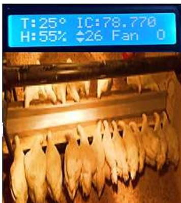
*Nota:* En la figura se muestra el control de temperatura y humedad en el rango de 26 si es menor se activan los focos.
