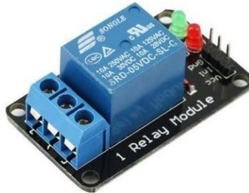
*Nota:* Esta figura representa a un relevador 1 canal. Tomado de (Módulo Relé 1 Canal | AV Electronics, s. f.).
