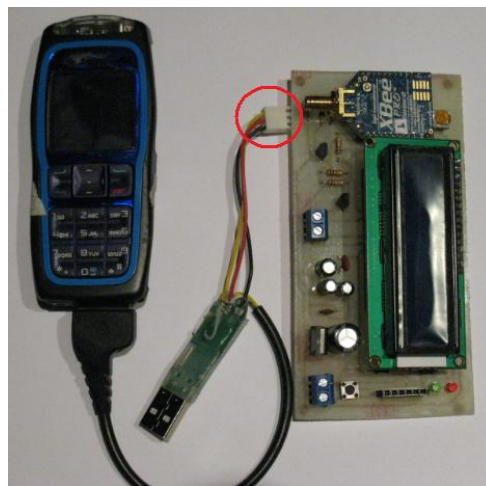
Figura 4. 7. Conexión del Nokia 3220 a la placa coordinador Xbee
