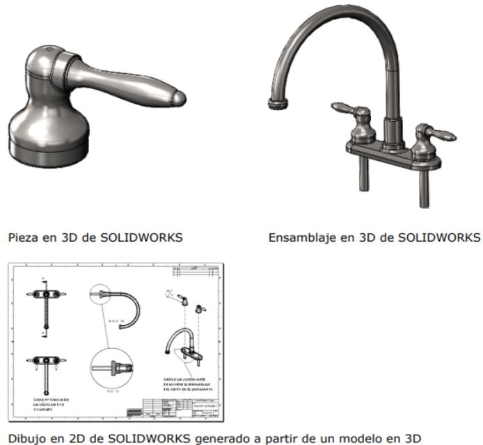
*Nota.* El gráfico representa diseños realizados en SolidWorks en 2D y 3D. Tomado de *Introducción a SolidWorks* (p.13), por Microsoft Corporation (2012), Dassault Systemes.
