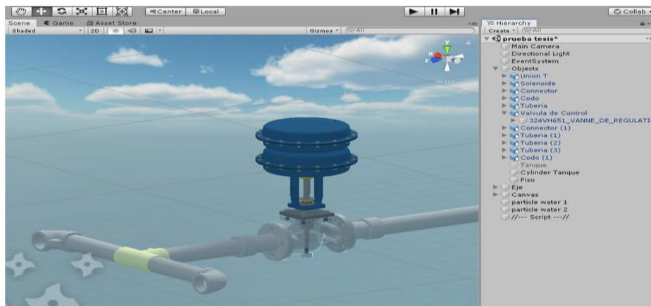
*Nota.* La figura representa el montaje del posicionador electroneumático con la válvula de control, la tubería recta y el conector con brida, la tubería en T y el codo de 90° en la vista lateral de escena de Unity.
