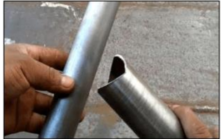
Unión de tuberías con corte boca de pez.
