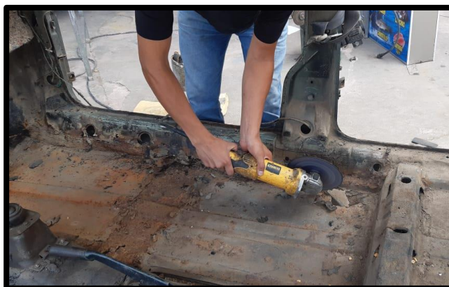
Corte de pisos en mal estado
