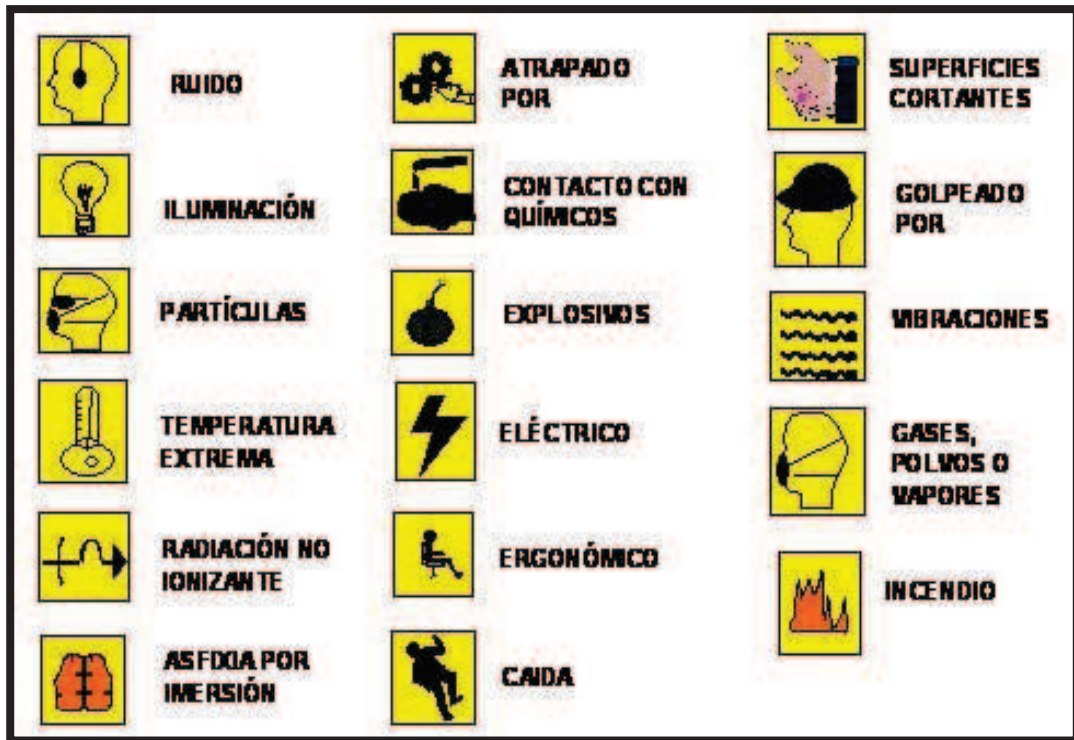
Figura 2.10 Simbología de Señalización Industrial
