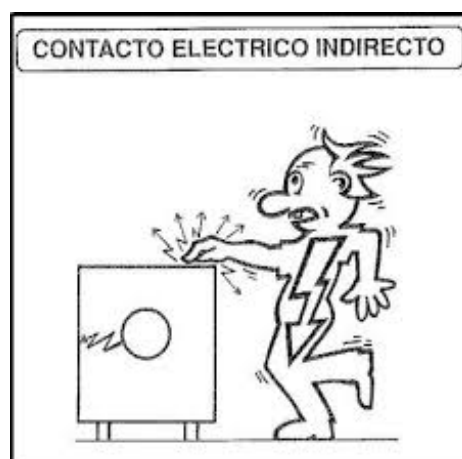
Figura 5. Contacto eléctrico indirecto
