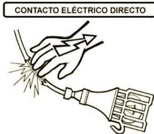
Figura 4. Contacto eléctrico directo
