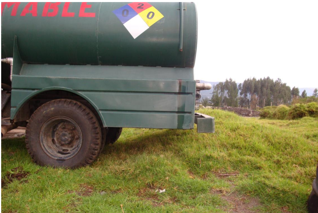
Figura 6 En esta figura podemos observar uno de los vehículos que se utilizan para el transporte del combustible aéreo que no cuenta con el dispositivo de conexión a tierra.
