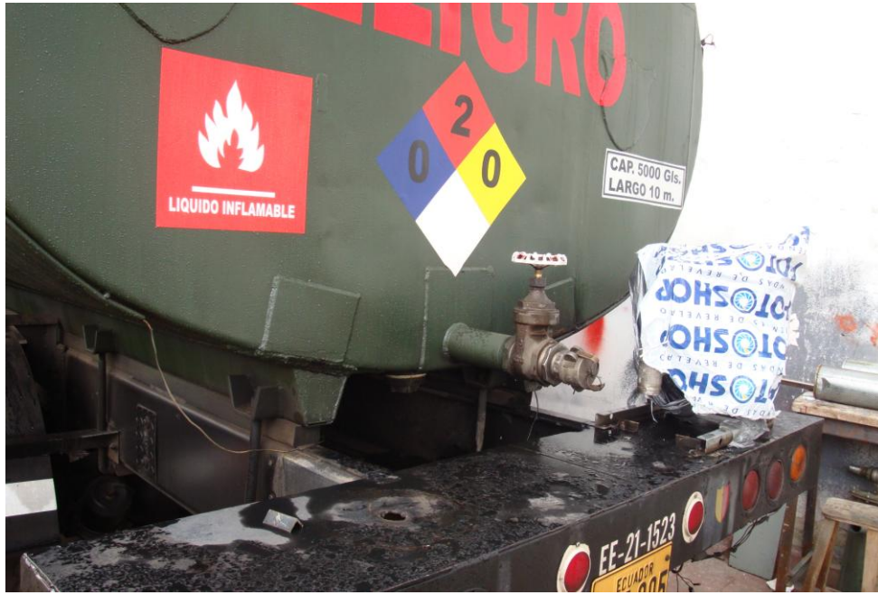
Figura 7 En esta figura podemos observar otro de los vehículos que se utilizan para el transporte del combustible aéreo que no cuenta con la suficiente señalización (mantenga su distancia) para el transporte del combustible aéreo.
